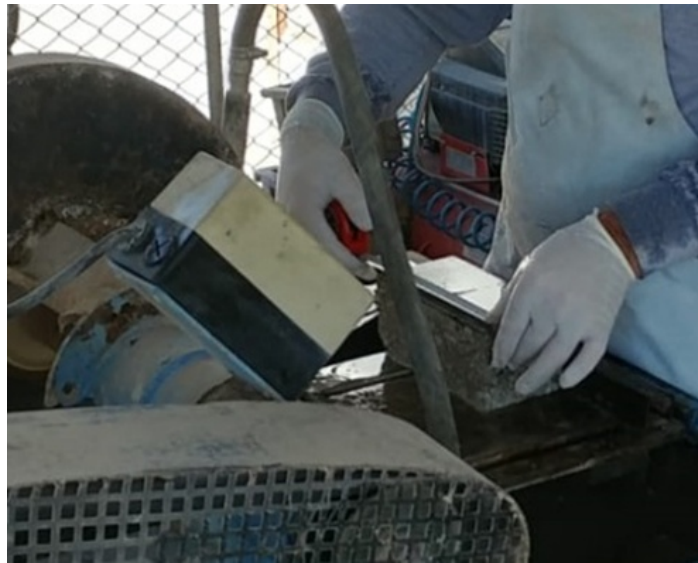
Şekil 3.9. Beton parkenin kesim işlemi (Numunelerin, üst yüzeyi 7500 mm 2 'den küçük, 25000 mm 2 'den büyük olmamalı ve kalınlığı en fazla 103 mm olmalıdır.)
