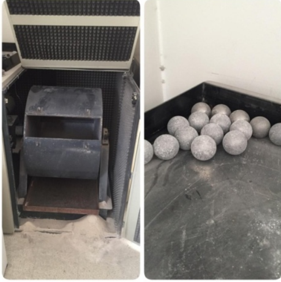
Şekil 3.9. Parçalanma Direncinin Tayini Deney Düzeneği
