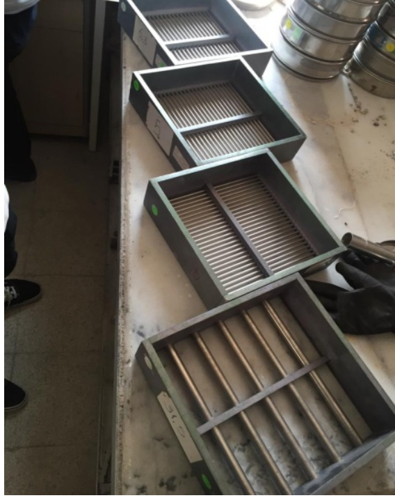
Şekil 3.8. Yassılık İndeksi Deney Düzeneği
