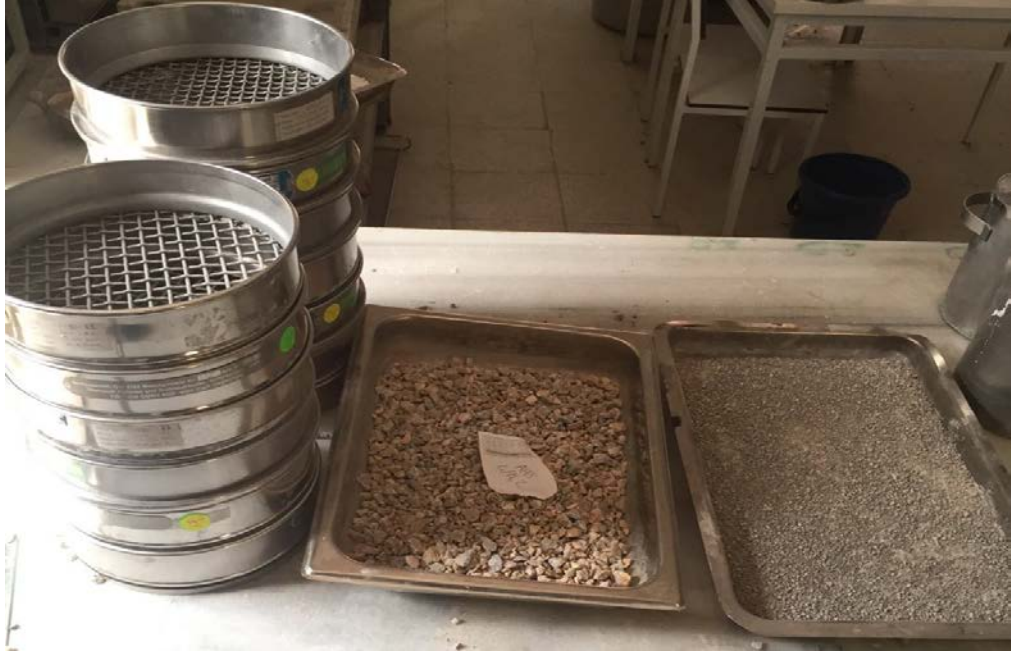
Şekil 3.5. Elek Analizi Deney Düzeneği
