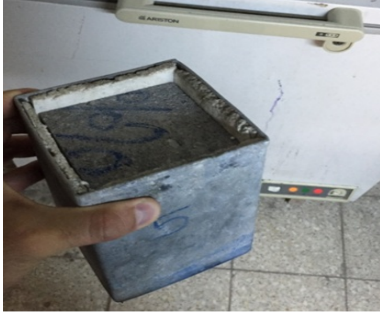
Şekil 3.10. Buz Çözücü Tuz Etkisiyle Birlikte Donma Çözülme Etkisine Direnç Deneyi Numunesi
