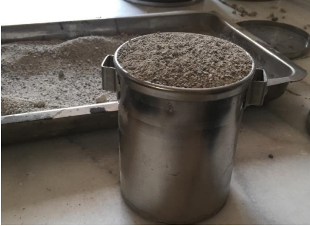
Şekil 3.6. Gevşek ve Sıkışık Birim Hacim Tayini Deney Düzeneği
