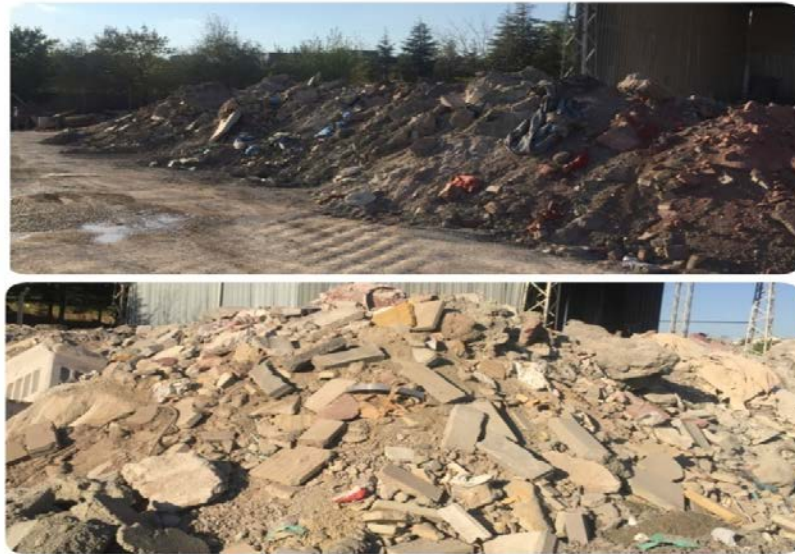
Şekil 3.3. Bir Üretim Tesisinde Atık Halde Bulunan Prefabrik Beton Elemanlar
