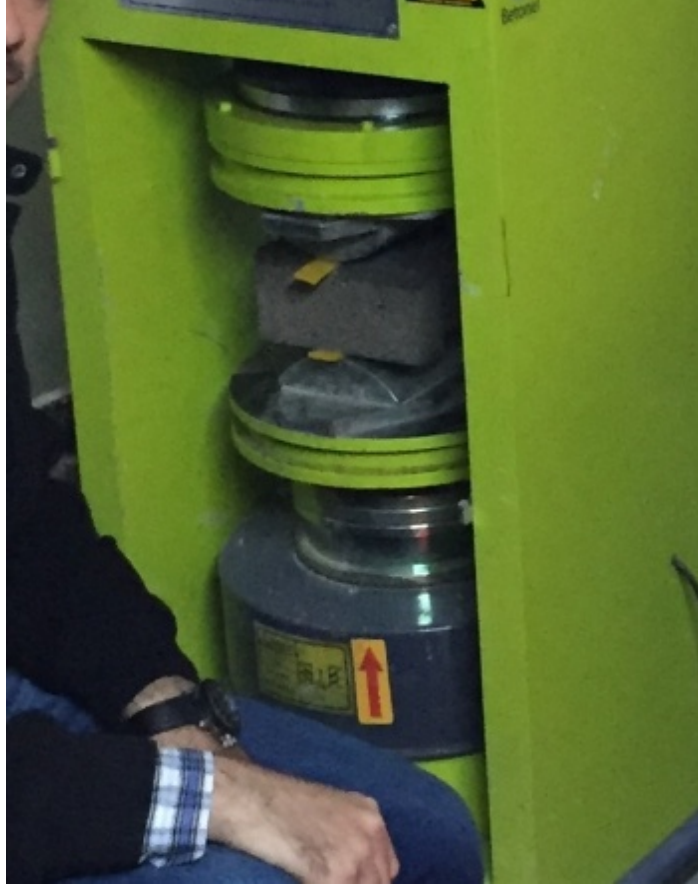
Şekil 3.13. Yarmada çekme deneyi düzeneği
