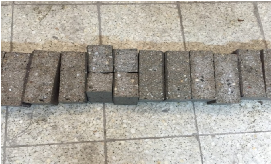
Şekil 3.14. Numunelere kırım işlemi uygulandıktan sonraki iç yüzey görüntüleri
