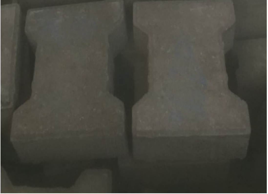
Şekil 3.12. Su Emmenin Tayini Deneyine Ait Numune Görünümü
