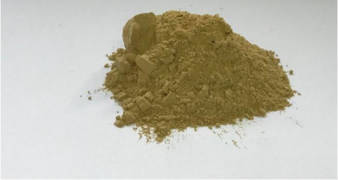
Şekil 3.3. Çalışmalarda bağlayıcı olarak kullanılan Na-bentonit numunesi.
