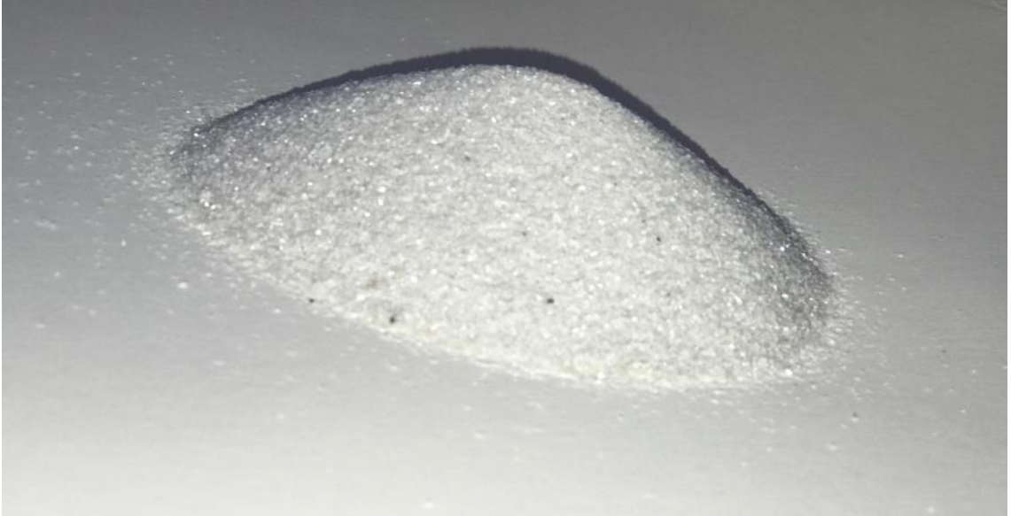
Şekil 3.5. Fırından çıkarılan sıcak pelet numunesinin oksitlenmesini önlemek amacı ile kullanılan kalsit.
