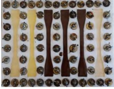
Şekil 3. ASTM D 638 standardına göre kalıplanmış kompozit numuneler.
