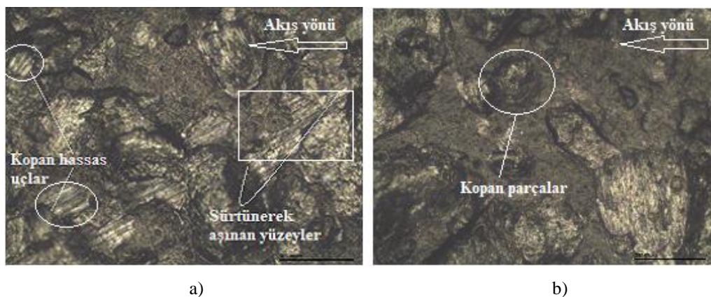
Şekil 5.11. Akdeniz suyu ile hazırlanan bulamaçtaki a) 30° ve b) 90° lik numunelerin x200 büyütme görüntüleri
