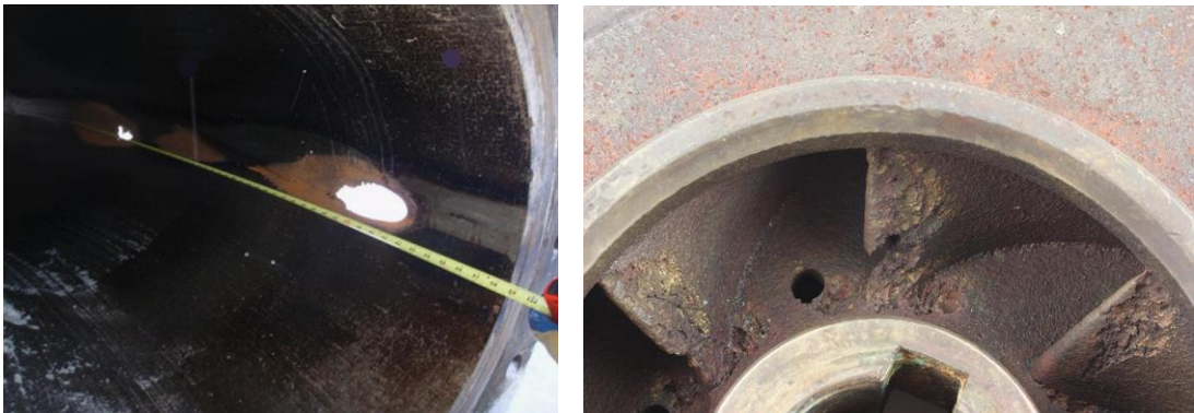
Şekil 3.8. Slurry erozyonunun görüldüğü endüstriyel aşınma örnekleri
