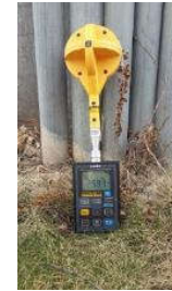
Şekil 6 (c) Zeminde direğin dibinde yapılan ölçümün fotoğrafı
