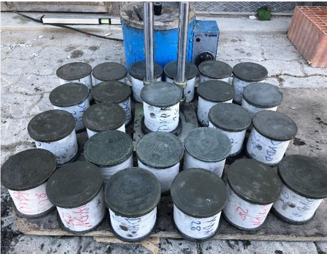
Şekil 6. Karot numunelerin başlık yapılması
