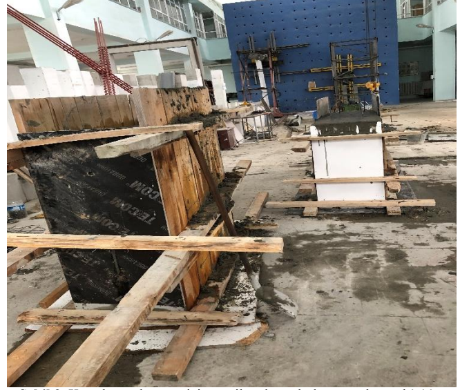
Şekil 2. Karotların alınması için üretilen donatılı donatısız beton bloklar
