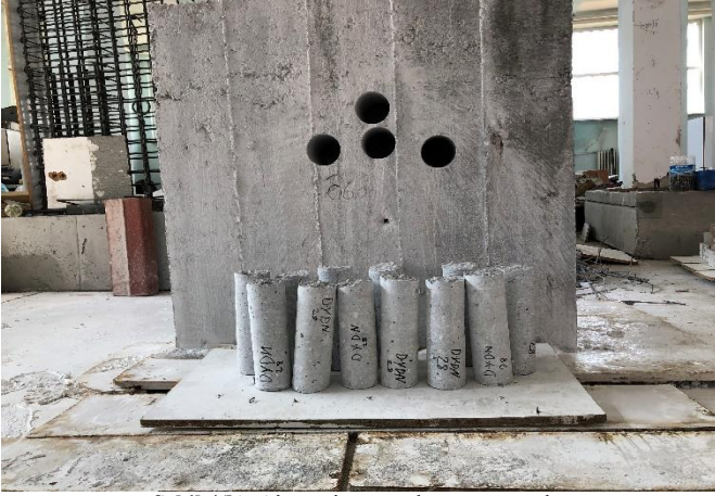
Şekil 4(b). Alınan donatısız karot numuneler
