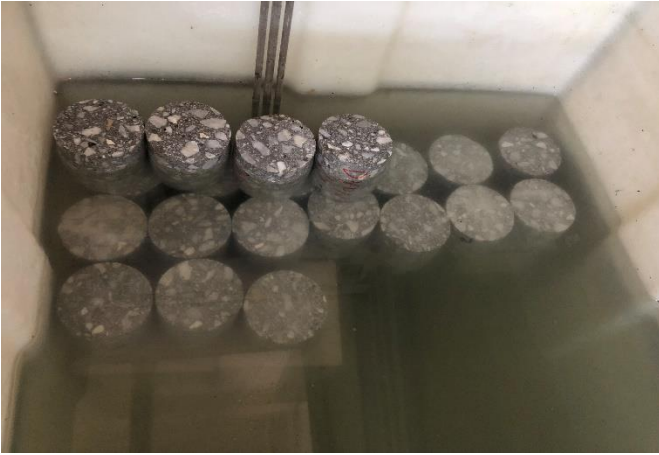
Şekil 5. Karotların su içinde kür edilmesi
