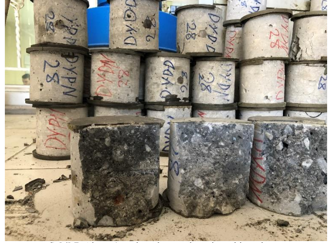
Şekil 7. Alınan karotların basınç deneyine tabi tutulması
