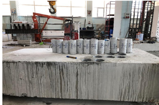
Şekil 4(a). Alınan donatılı karot numuneler
