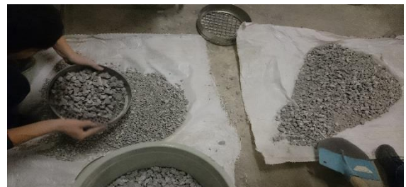
Şekil 1. Geri dönüşüm agregaların elekler yardımı ile gruplara ayrılması
