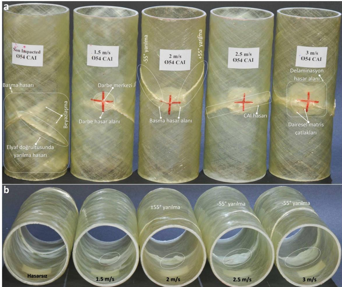
Şekil 5.23. Ø54 CTP borularda basma deneyi sonrası oluşan hasar görüntüleri
