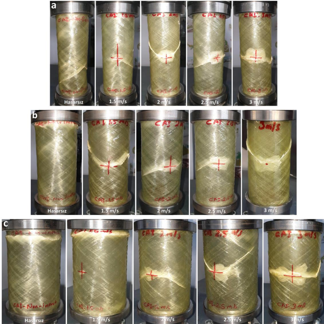
Şekil 5.16. CTP boruların CAI sonrası genel görüntüleri a) Ø54 mm b) Ø72 mm c) Ø96 mm
