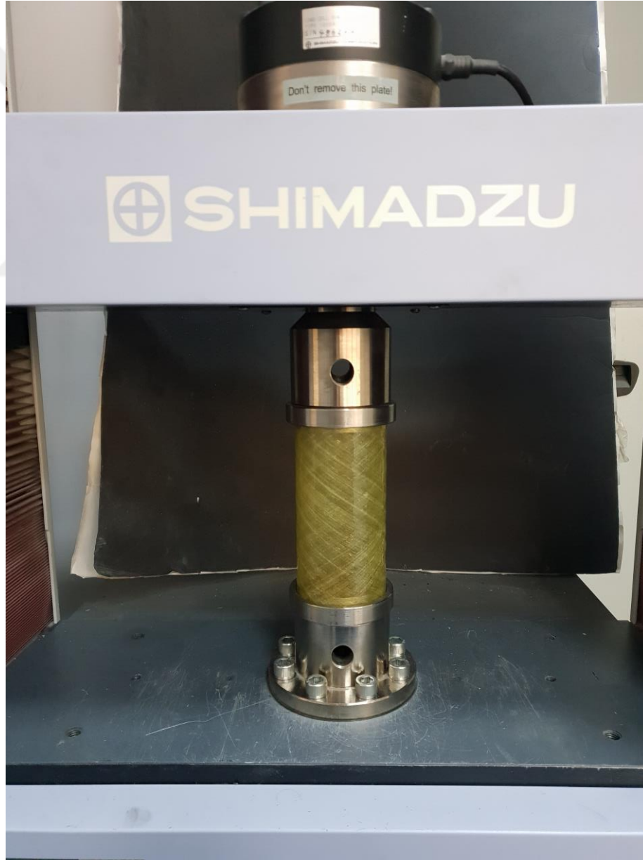
Şekil 4.11. Basma deneylerinde kullanılan çekme test cihazı
