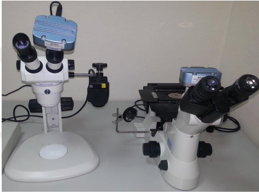
Şekil 4.9. Mikro hasarın incelenmesinde kullanılan KOZO marka USB mikroskop kameralar
