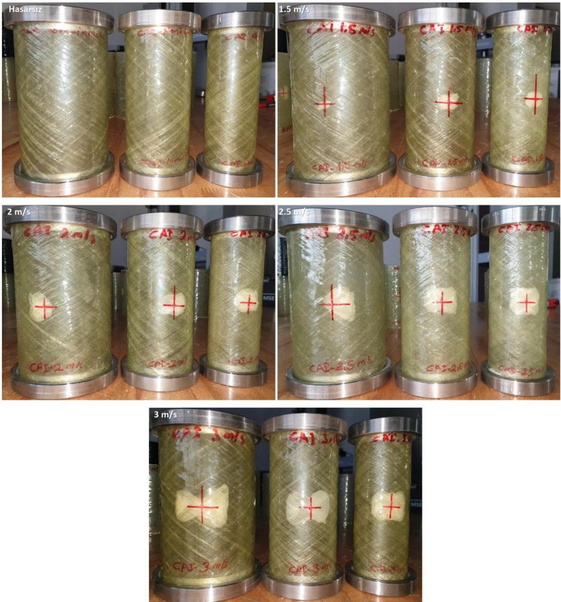
Şekil 4.12. Basma deneyleri için hazırlanmış hasarsız ve 1.5, 2, 2.5, 3 m/s hızlarda darbe ön hasarlı numunelerin flanşlı genel görünüşü
