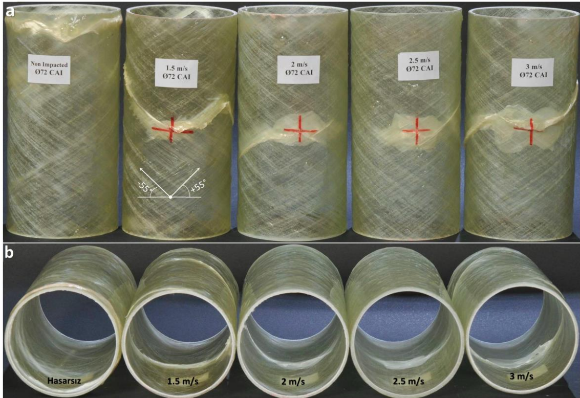
Şekil 5.24. Ø72 CTP borularda basma deneyi sonrası oluşan hasar görüntüleri
