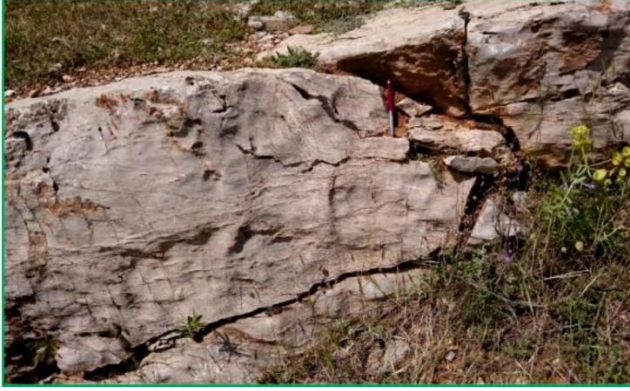
Şekil 5. Kalın tabakalı, bol çatlaklı, kalsit ve demiroksit damarlı Çaltepe kireçtaşı (Göçeri Köyü kuzeybatısı).
