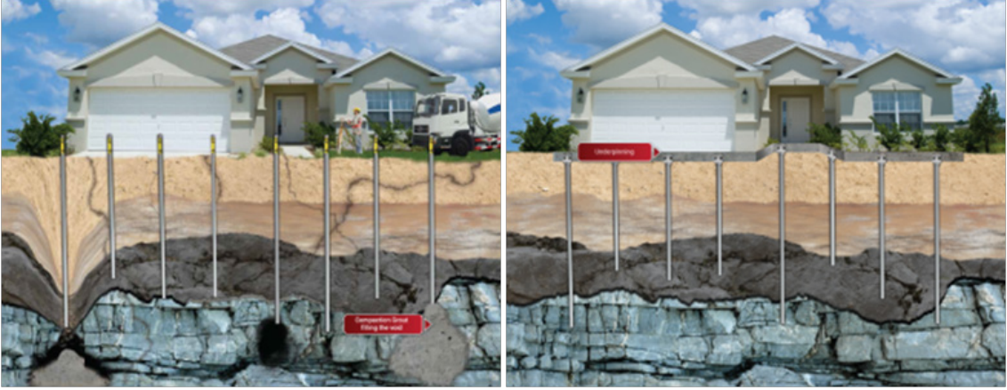
Şekil 83. Yeraltı destekleri ile yapı stabilitesinin sağlanması ( https://thesinkholeguy.com/sinkhole-repair-methods , 2023)
