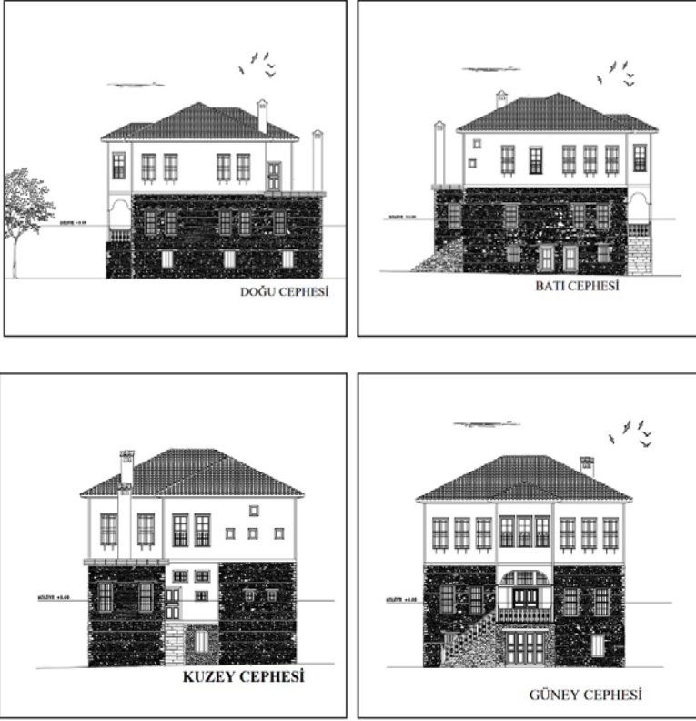
Şekil 12. Eray Erdem Evi Restitüsyon Cephe Çizimleri; Doğu, Batı, Kuzey ve Güney Cephesi
