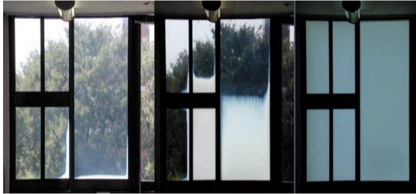
Şekil 6: Termokromik camın değişik durumlarda görünümleri (Karasu ve Sarıcaoğlu, 2018)
