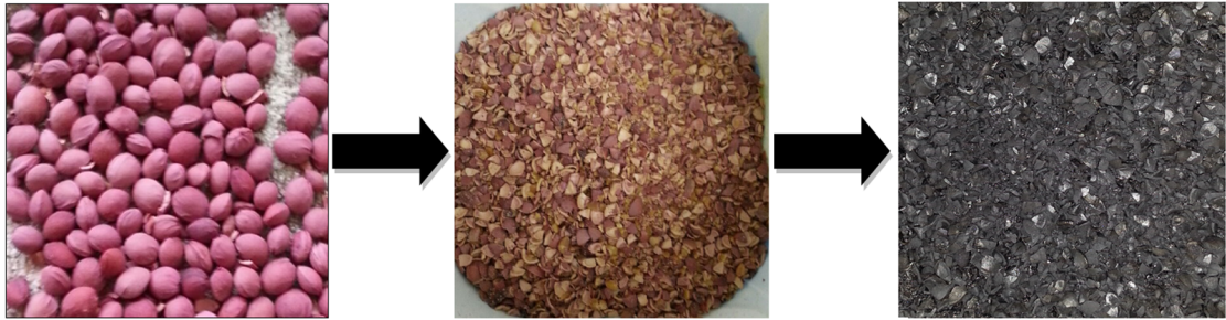
Şekil 3.2. Vişne çekirdeği kabuğundan pirolitik çarı elde edilme şeması
