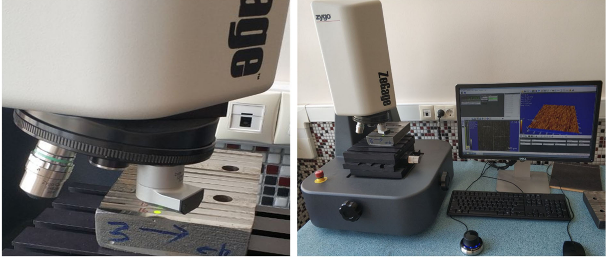
Şekil 2. 3D topografya ve Ra ölçümlerinde kullanılan optik tarayıcı
