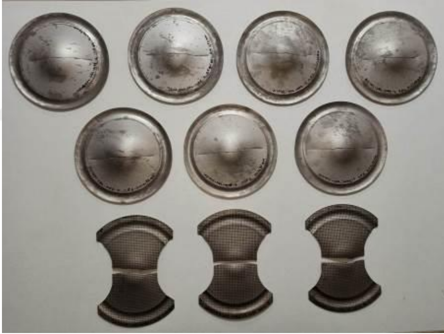
Şekil Ek-1.1. Farklı salınım parametreleri uygulanarak gerçekleştirilmiş Nakajima testleri
