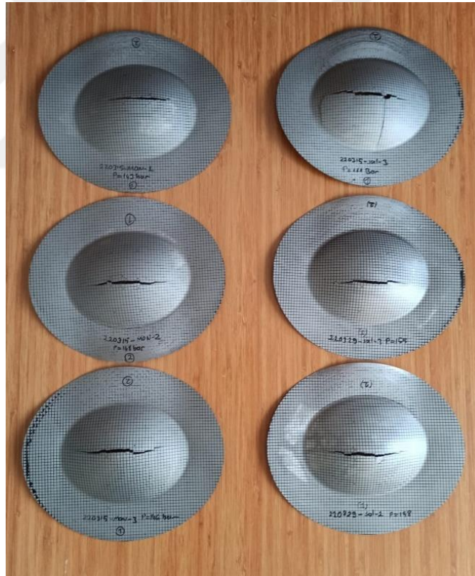
Şekil 3.17. 0.75 Elips oranlı kalıpla monoton ve salınımlı durumda yapılan hidrolik şişirme deney numuneleri
