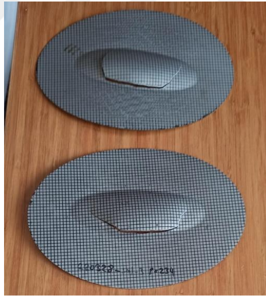
Şekil Ek-3.6. 0.3 elips oranlı hidrolik şişirme kalıbı ile yapılan deneyler
