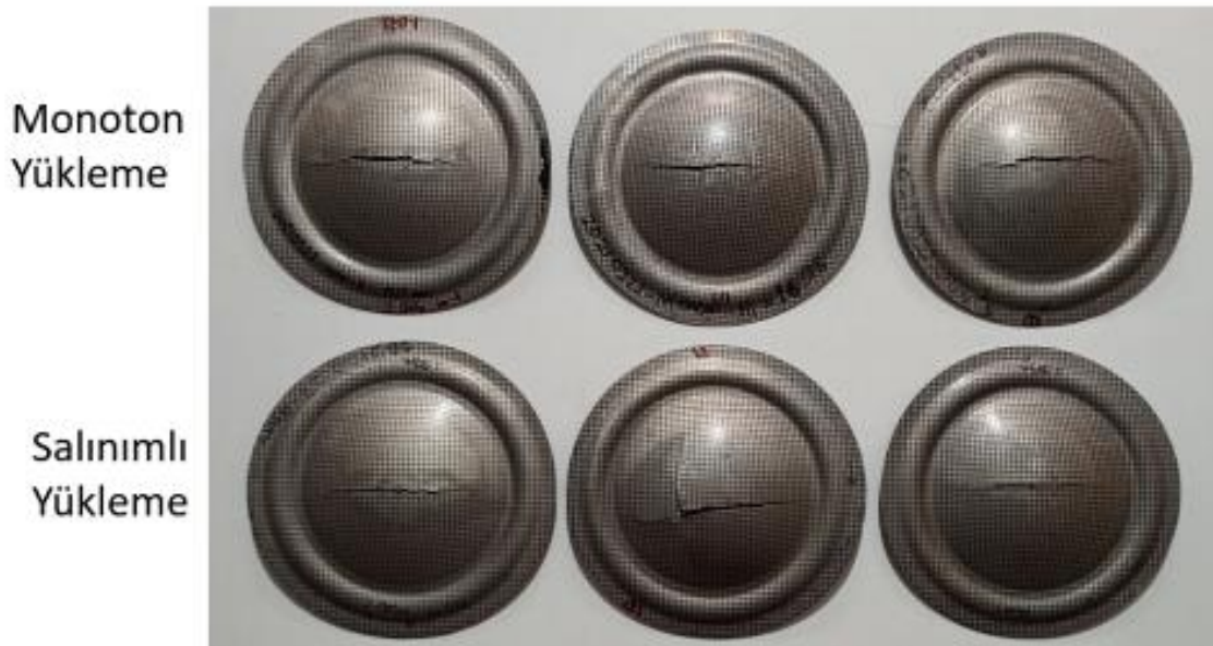
Şekil 3.11. Monoton ve salınımlı yükleme ile 100 mm çaplı dairesel kalıplarda şekillendirilmiş deney numuneleri
