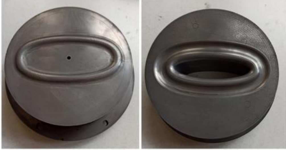
Şekil Ek-3.1. 0.25 Elips oranlı hidrolik şişirme kalıbı
