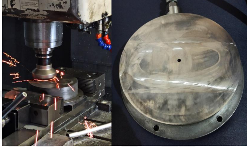
Şekil Ek-3.3. 0.25 Elips oranlı hidrolik şişirme kalıbının kilitleme çubuğunun kaldırılması
