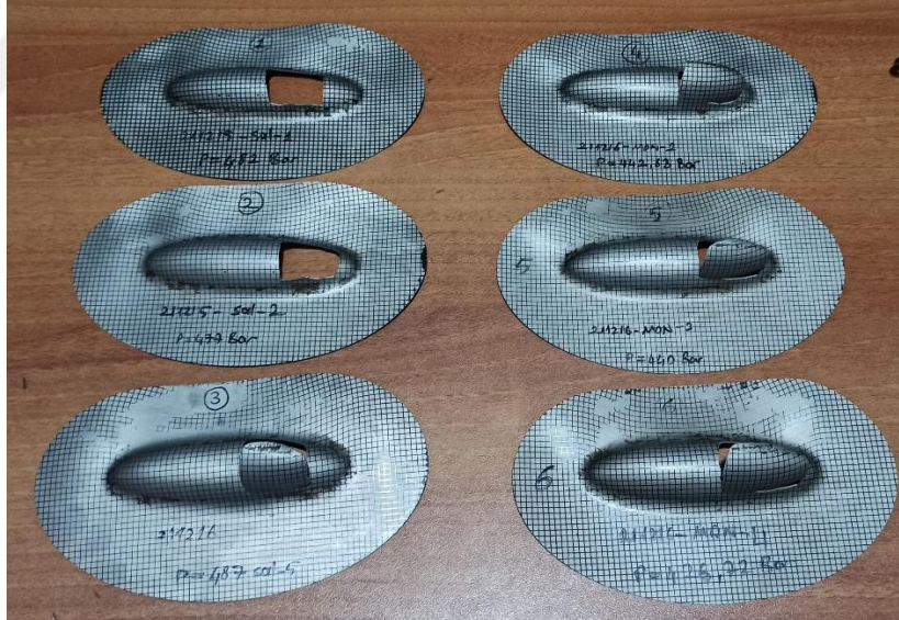
Şekil Ek-3.4. Kilitleme çubuğu kaldırıldıktan sonra yapılan deneyler
