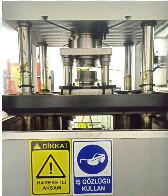
Şekil 3.1. Deney düzeneği (hidro-şekillendirme presi)
