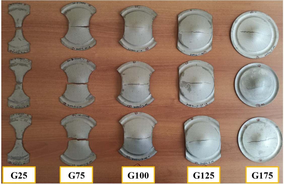
Şekil 3.6. Hasar oluşuncaya kadar şekillendirilmiş test numuneleri
