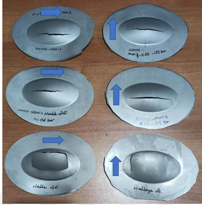
Şekil 3.13. Yapılan ön deneyler (oklar hadde yönünü göstermektedir)
