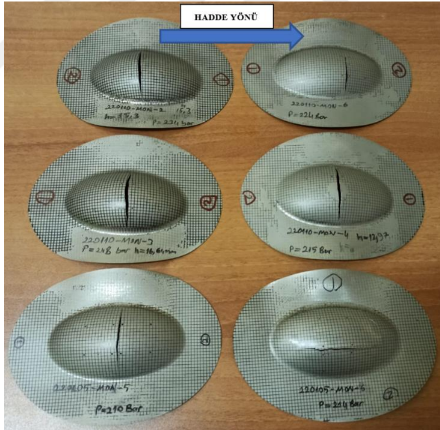
Şekil 3.14. Monoton yüklemeye ile 0.5 elips oranlı kalıplarda gerçekleştirilen deneyler
