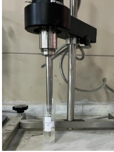
Şekil 3.4. Ultrasonik homojenizatörle katkının homojen hale getirilmesi
