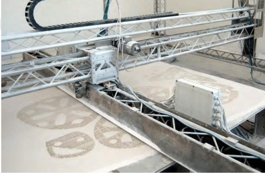
Şekil 1.5. D Shape tekniği ile kolon üretimi (Al Jassmi vd., 2018)
