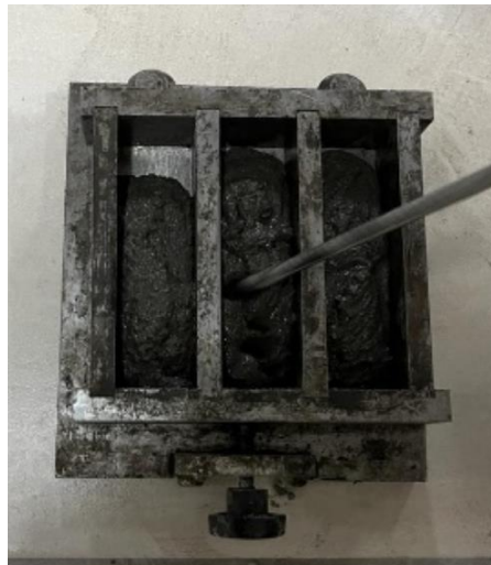
Şekil 3.8. Harçların kalıplara yerleştirilmesi
