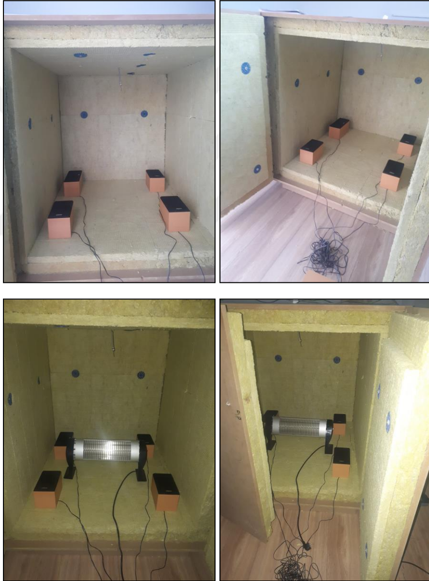
Şekil 3.59. 8 cm taş yünü yalıtım malzemesine ait deney düzeneği
