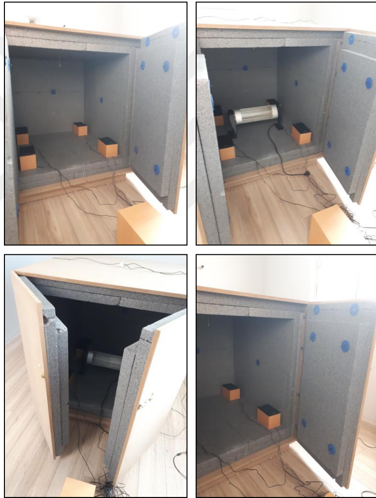
Şekil 3.34. 10 cm EPS karbonlu yalıtım malzemesine ait deney düzeneği
