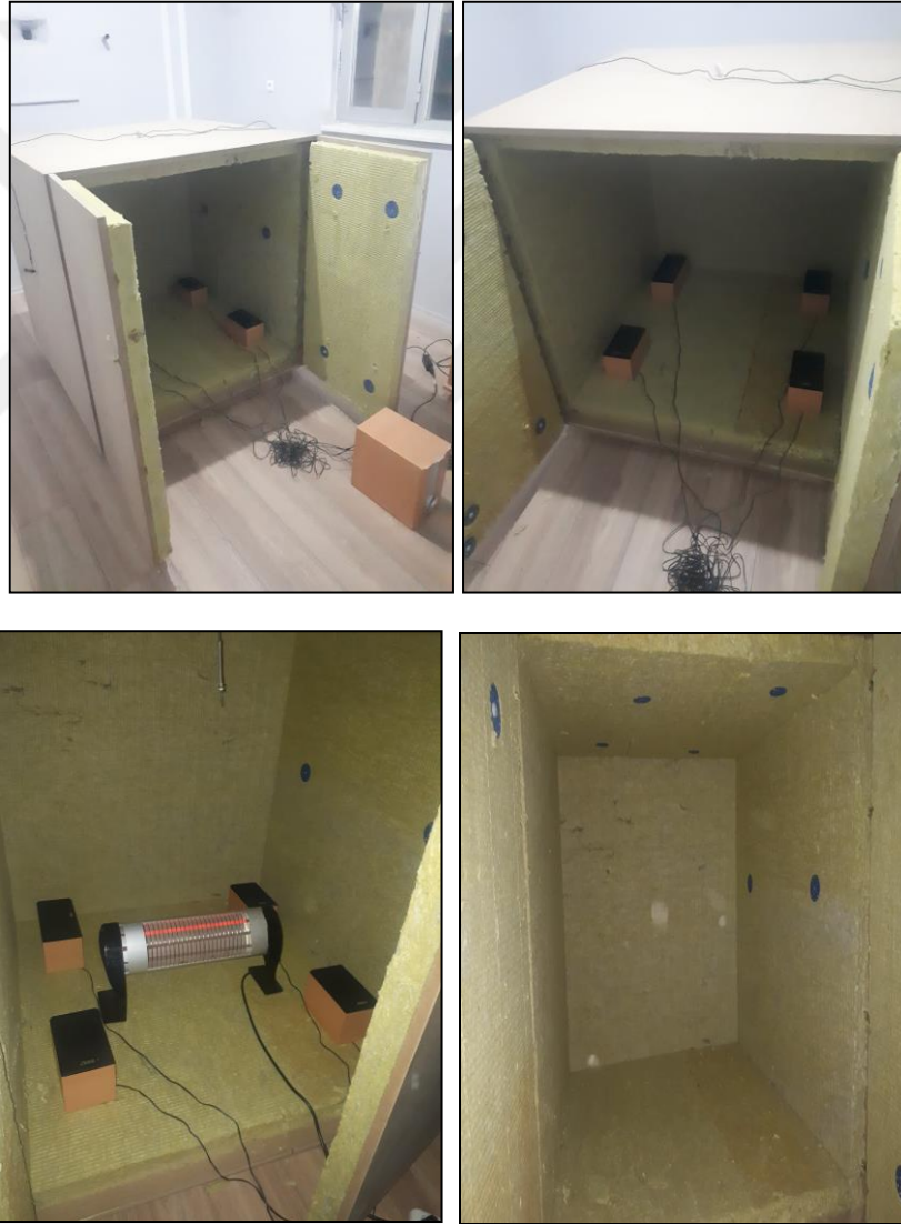
Şekil 3.54. 5 cm taş yünü yalıtım malzemesine ait deney düzeneği
