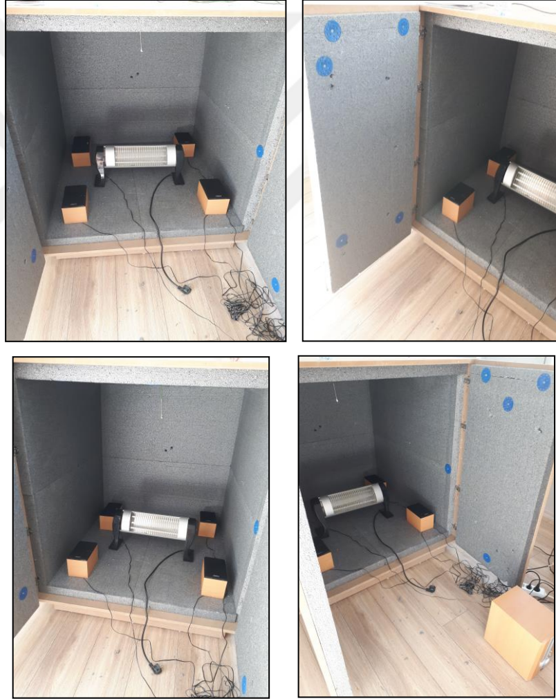
Şekil 3.24. 5 cm EPS karbonlu yalıtım malzemesine ait deney düzeneği
