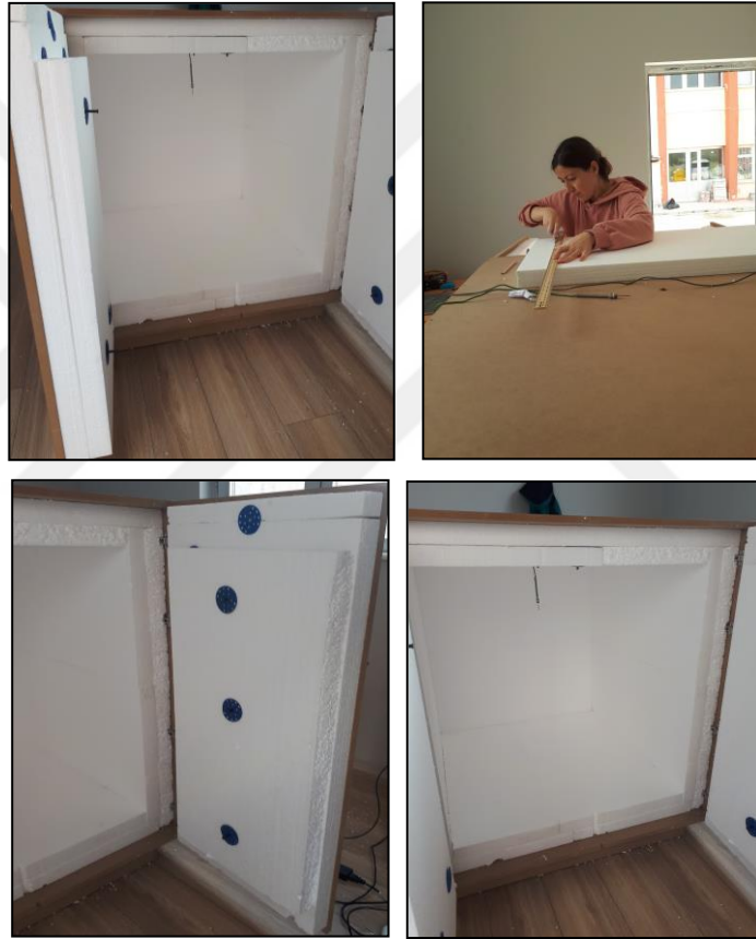
Şekil 3.19. 10 cm EPS beyaz yalıtım malzemesine ait deney düzeneği
