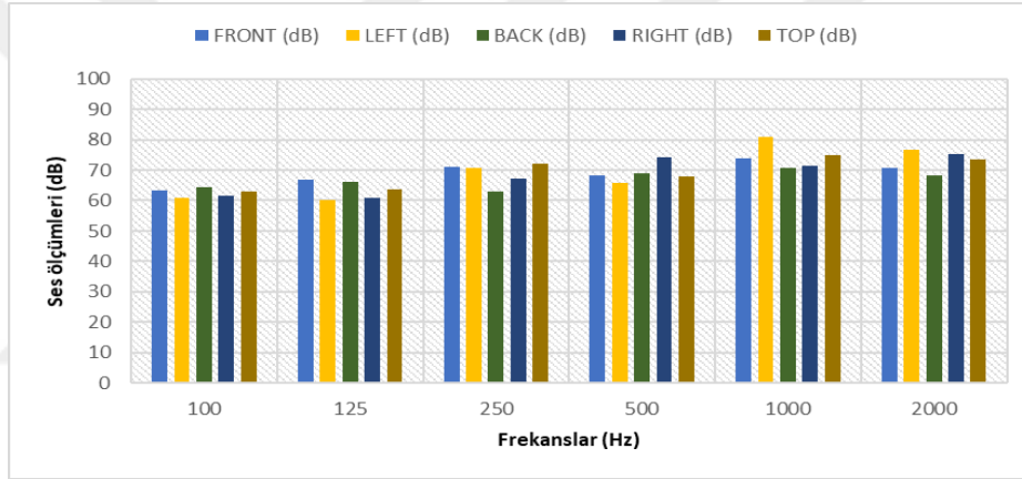
Şekil 3.76. 1,5 cm koyun yünü yalıtım malzemesine ait tüm sıcaklıklarda 5 farklı dış yüzeydeki ortalama desibel ölçümleri
