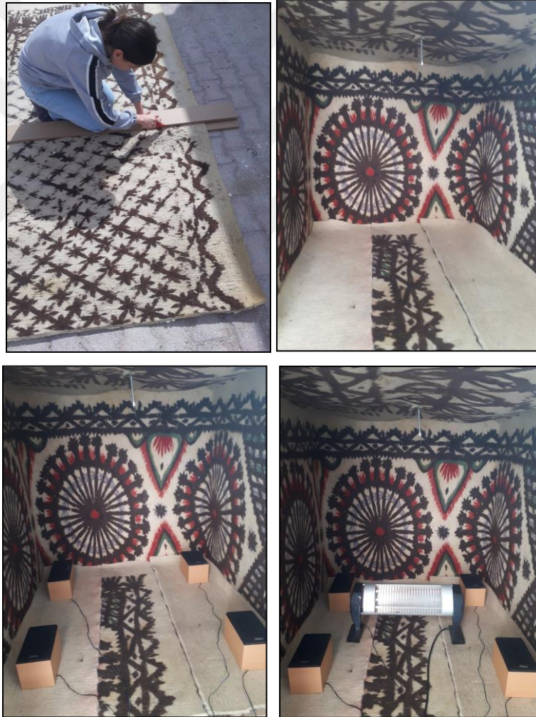
Şekil 3.74. 1,5 cm koyun yünü yalıtım malzemesine ait deney düzeneği
