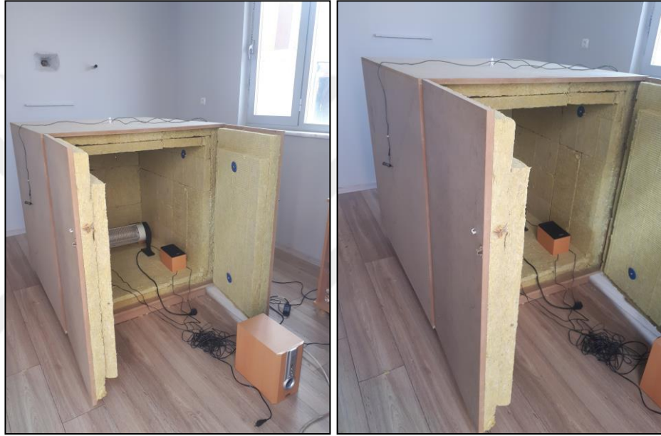
Şekil 3.64. 10 cm taş yünü yalıtım malzemesine ait deney düzeneği
