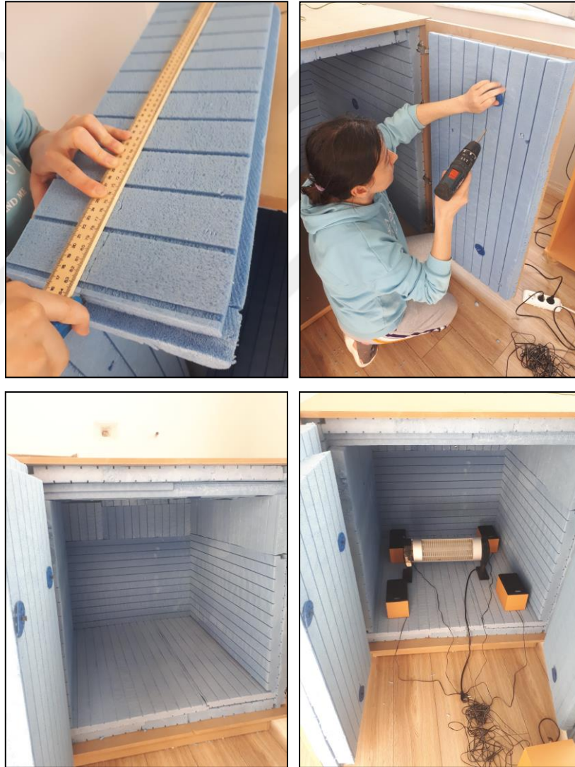
Şekil 3.49. 10 cm XPS yalıtım malzemesine ait deney düzeneği
