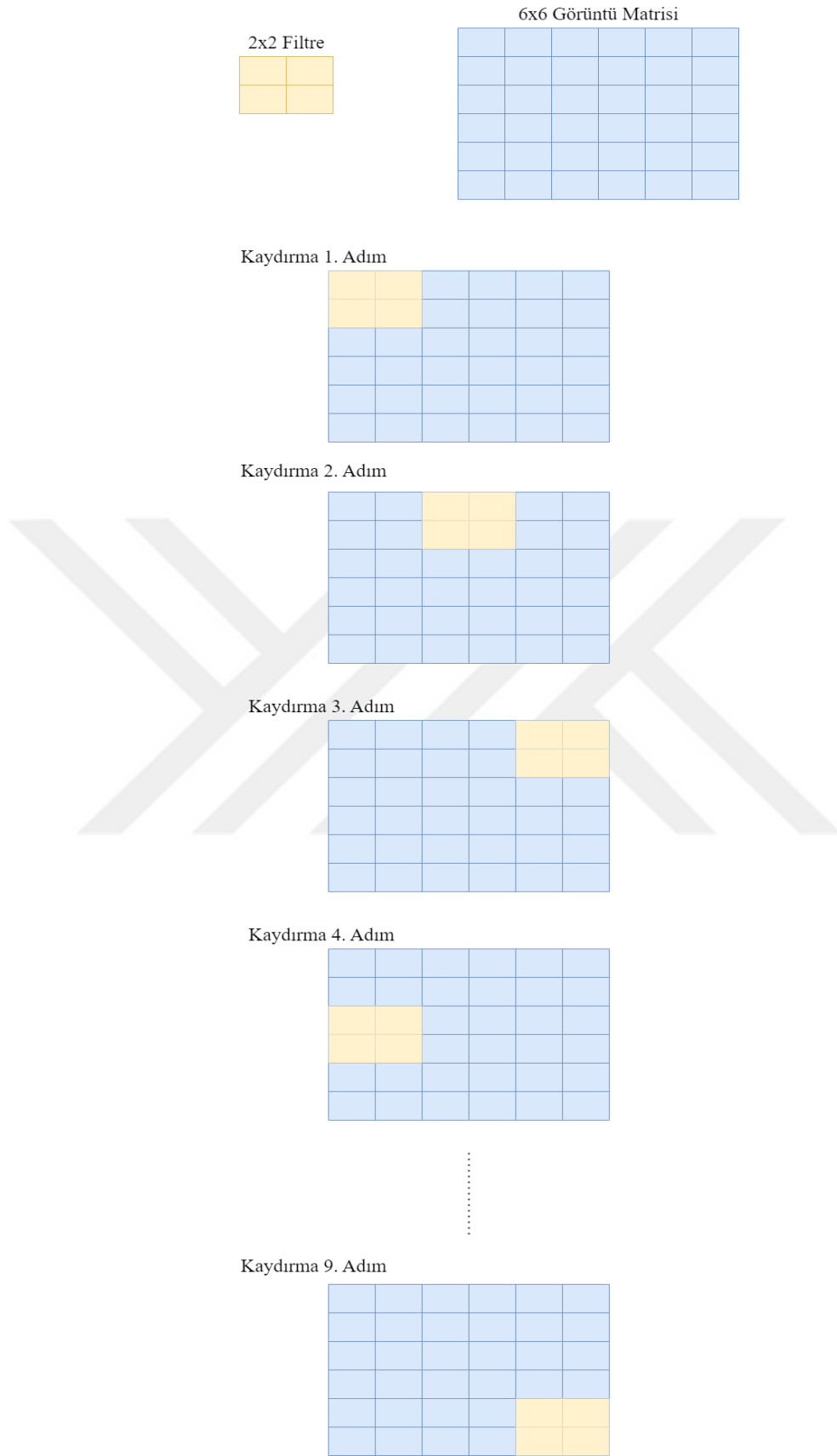
Şekil 3.6. Adım aralığı 2 olarak belirlenen filtrenin (kernel) görüntü matrisi üzerinde kaydırılması (Wahyudi Setiawan ve ark 2019)
