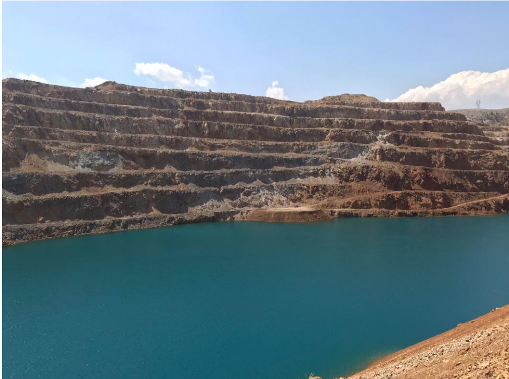
Şekil 2.18. Attepe demir yatağında uzun yıllar devam etmiş olan açık işletme faaliyetleri sonucunda ortaya çıkan işletme basamakları, pasa sahaları ve ocak yeri çukurluğunun oluşturduğu yeni morfoloji ve rehabilitasyon çalışmaları kapsamında oluşturulan yeraltı suyu göletinin Mağarabeli mevkiinden GD' ya doğru yapılan bir bakış ile uzaktan görünümü
