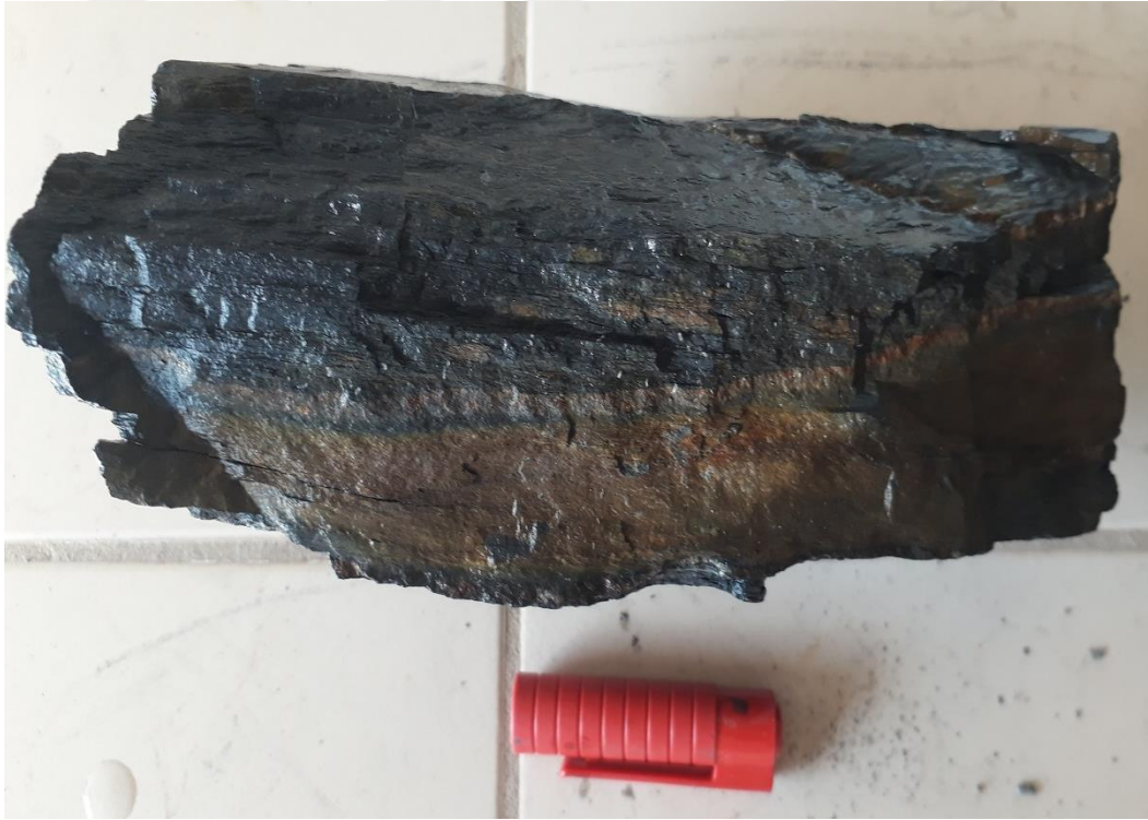
Şekil 2.12. Attepe formasyonuna ait koyu gri-siyah renkli organik maddece zengin şeyl kesimleri ile sarımsı gri renkli kalsit-siderit ve piritçe zengin karbonat kesimlerinin birbirleriyle ardalanmalı, yanal ve düşey yönlü tedrici geçişli, çapraz laminalı-bantlı sedimanter yapı örnekleri
