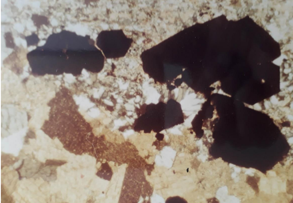
Şekil 3.6. Alttaki yer alan kireçtaşı ile üstte bulunan çamurtaşı-silttaşı bölümleri arasında çökelmiş siyah renkli iri öz şekilli pirit kristalleri ile onlar üzerinde büyümüş olan kısmen ışınsal yapıya sahip diyajenetik kökenli ikincil kuvars (beyaz) ve kalsit (bej) kristalleri, Çift nikol, 100X
