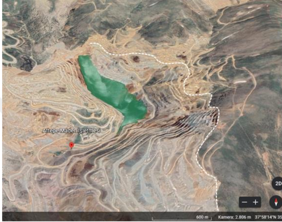
Şekil 1.3. Terk edilmiş Attepe demir yatağının doğu kesiminde yüzeyleyen Attepe formasyonuna ait gri-koyu gri-siyah renkli bitümlü çamurtaşı-şeyl ve karbonatlar, maden işletmesi ile ilgili şev ve basamaklar ve yatak tabanında oluşan tatlı su göleti. Beyaz renkli kesikli çizgi bitümlü çamurtaşı-şeyl-karbonat biriminin metakumtaşları ile tedrici geçişli üst sınırını göstermektedir
