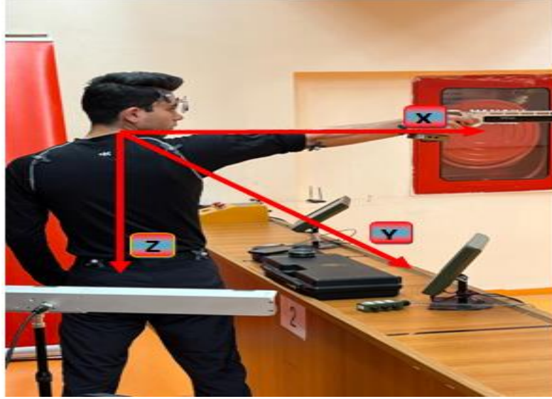
Şekil 3.30. Ölçüm anında kullanılan koordinat sistemi ve eksenler
