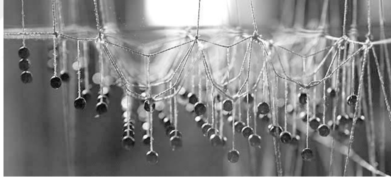
Şekil 2.3. Gaudi'nin Sagra da familia Bazilikası'nda optimize edilmiş yapı formunu bulmak için deneysel asma modeli (Heidari ve diğ., 2018).
