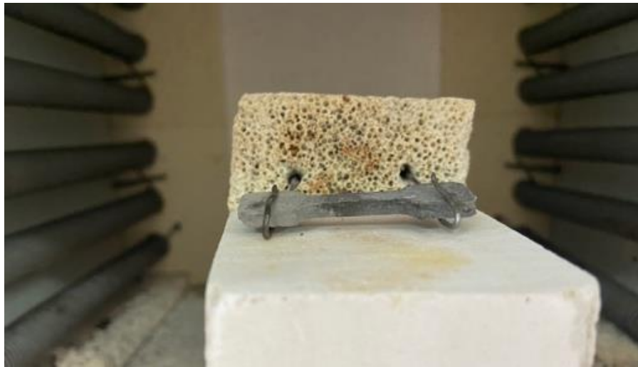
Şekil 3.4. Flaş sinterleme deney düzeneği
