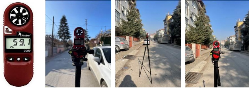
Şekil 3.13. Kalibrasyon için yerinde alınan meteorolojik ölçümlerden görseller
