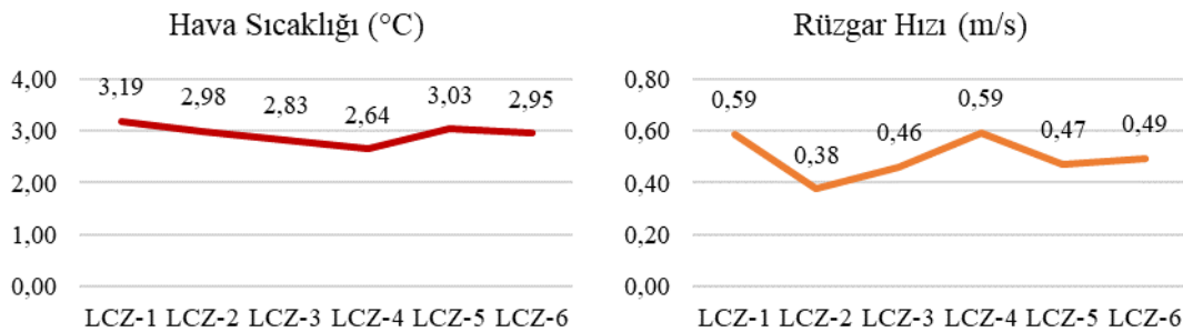
Şekil 4.96. Kış mevsimine ait dış ortam termal konfor hesabında kullanılan hava sıcaklığı ve rüzgâr hızı parametrelerinin farklı yerel iklim bölgelerinde karşılaştırılması
