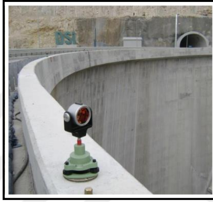
Şekil 2.4. Baraj Ölçmelerinde Kret Üzerindeki Obje Noktası (İnal ve Bülbül, 2013).
