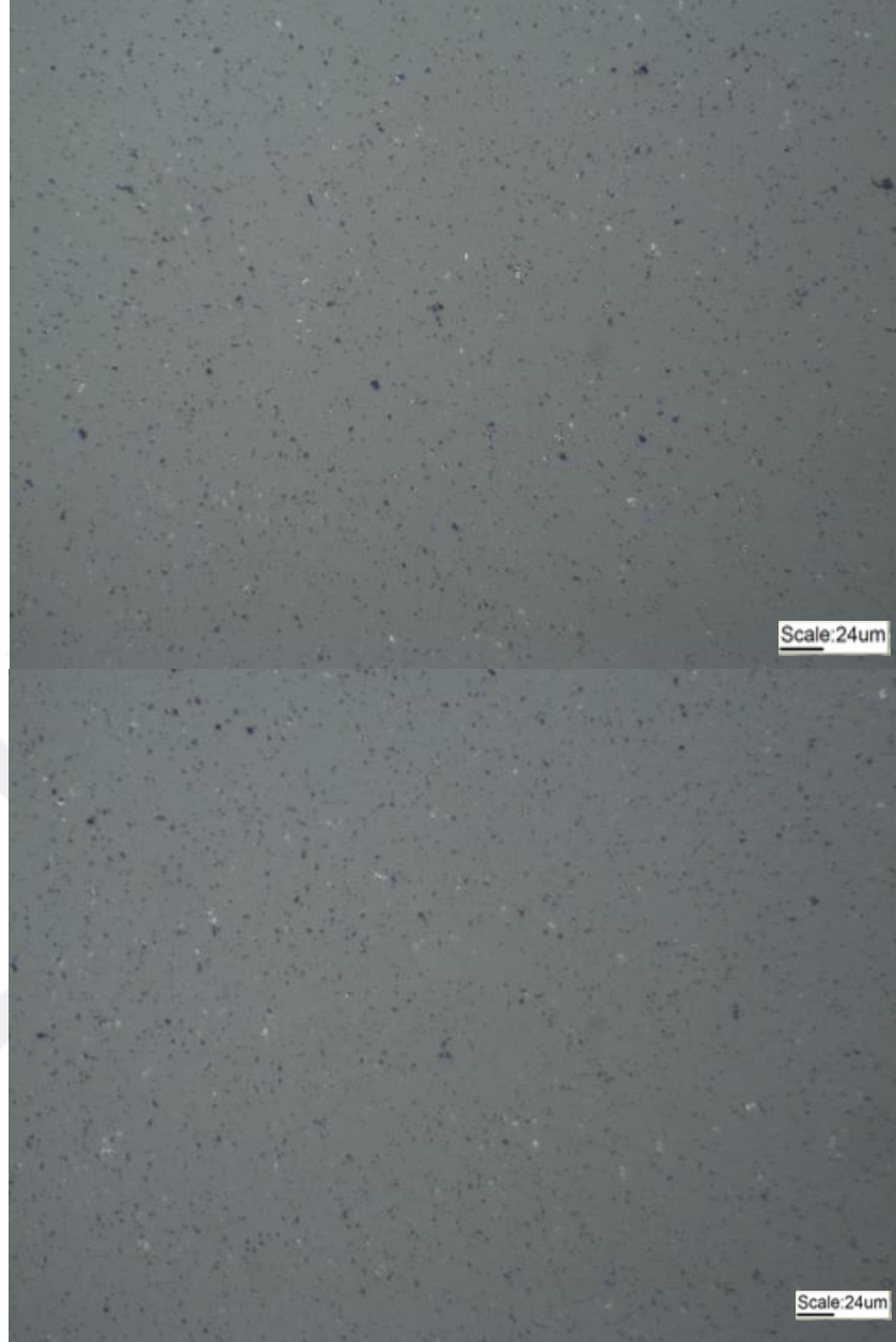
Şekil 4.14. Satın alınan MAX fazında sentezden önce boyut ayrımı yapıldıktan sonra büyük MAX'ların başlangıç maddesi olarak kullanıldığı sentezdeki MXene'lerin (sentez esnasında üstüne kapak kapatılan) optik mikroskop görüntüleri
