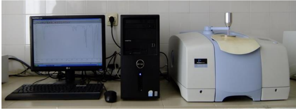
Şekil 3.1. Mxene analizinde kullanılan FTIR spektrofotometresi
