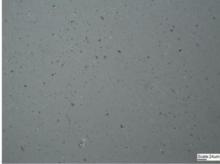
Şekil 4.12. Satın alınan MAX tozundan boyut ayrımı yapılmadan elde edilen MXene'lerin optik mikroskop görüntüleri
