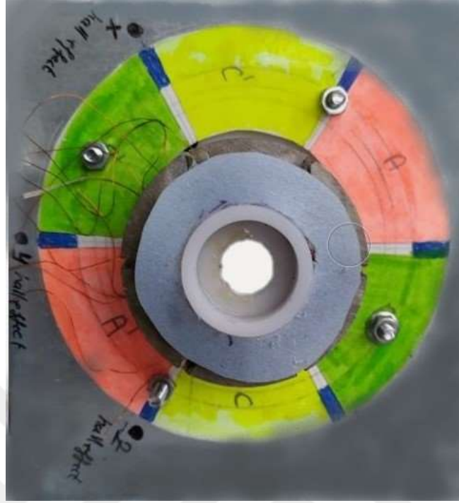
Şekil 3.4. US1881 Hall effect sensörlerin fazların konumuna göre yerleşimi.
