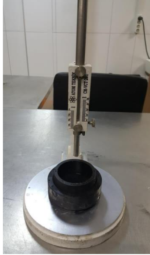
Şekil 3.4. Manuel vikat cihazı ve vikat kalıbı
