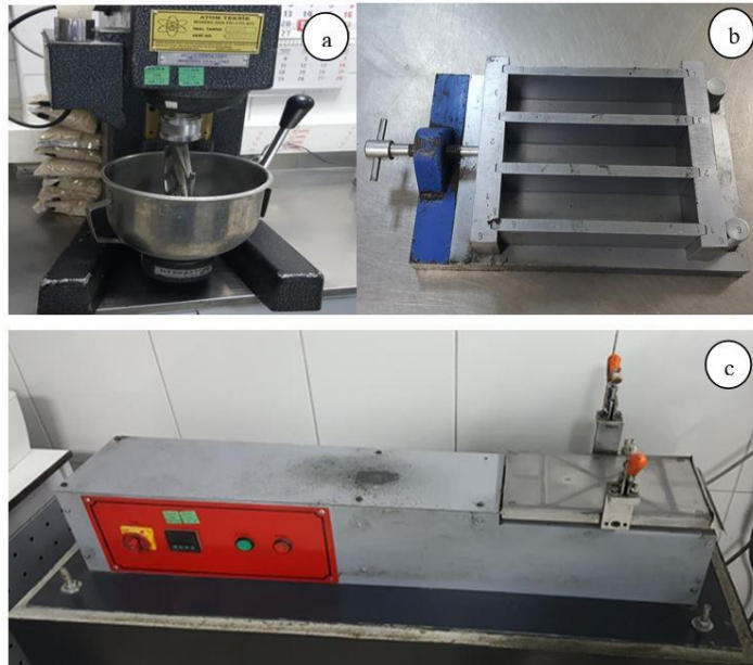
Şekil 3.3. (a) harç karıştırma makinesi ve karıştırma kabı, (b) üç gözlü çelik beton kalıbı, (c) sarsma cihazı
