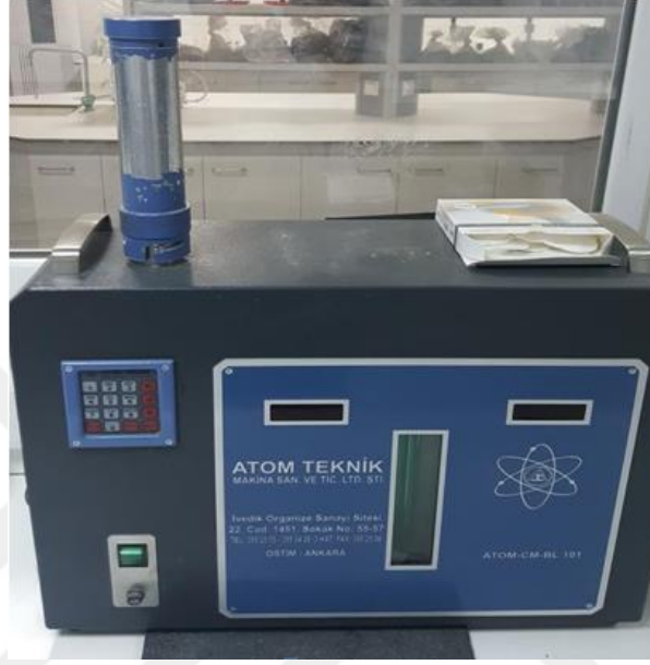
Şekil 3.1. Otomatik Blaine cihazı
