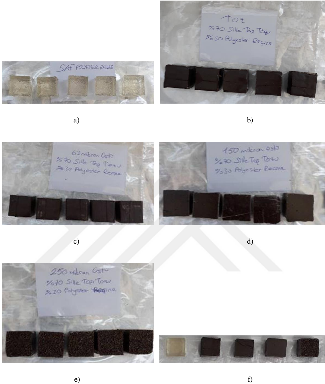
Şekil 3.10. (a) Saf PR, (b) Reçine63-70, (c) Reçine150-70, (d) Reçine 250-70, (e) Reçine500-70, (f) Fotoğrafta soldan sağa doğru numuneler sırasıyla saf PR, Reçine63-70, Reçine150-70, Reçine250-70 ve Reçine500-70
