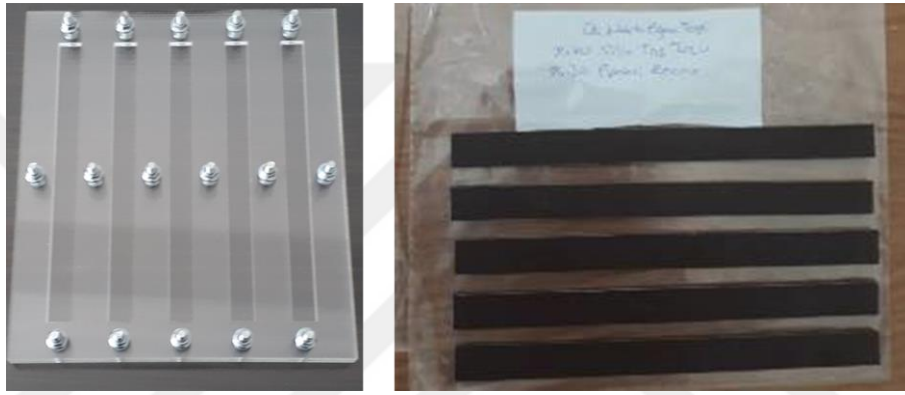
Şekil 3.21. ASTM D790 standardına göre üç nokta eğme testi için numunelerin yapılması
