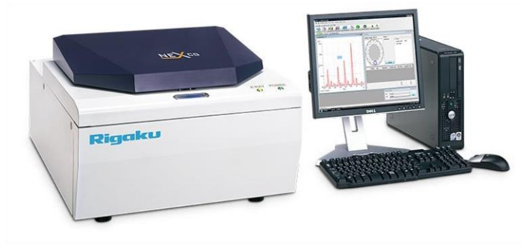
Şekil 3.12. STT'nin kimyasal içeriğinin Rigaku – NEX-CG cihazı, X-Işını Floresans Spektrometresi ile (XRF) belirlenmesi (URL, 2)
