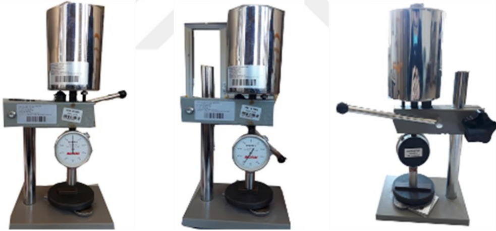
řekil 3.25. Kompozitlerin Shore-D cihazı ile sertlik deđerlerinin belirlenmesi
