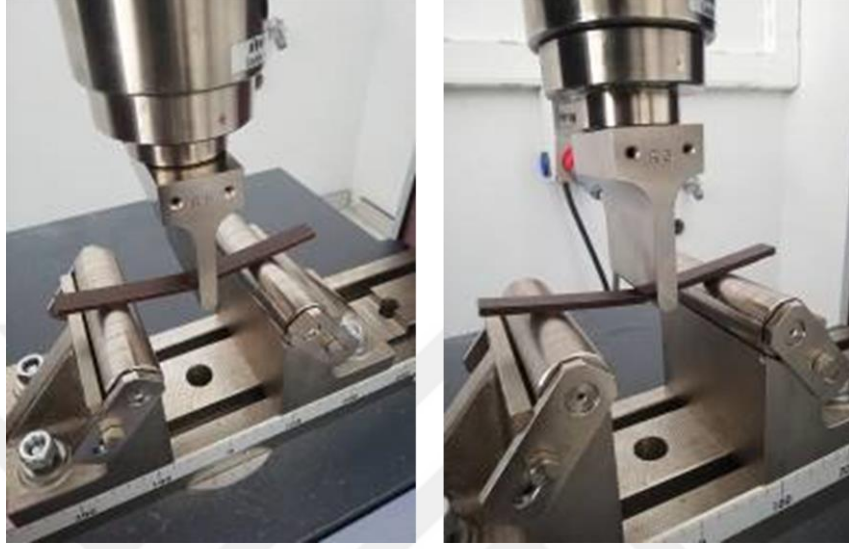
Şekil 3.22. Hazırlanan numunelere üç nokta eğme testinin uygulanması
