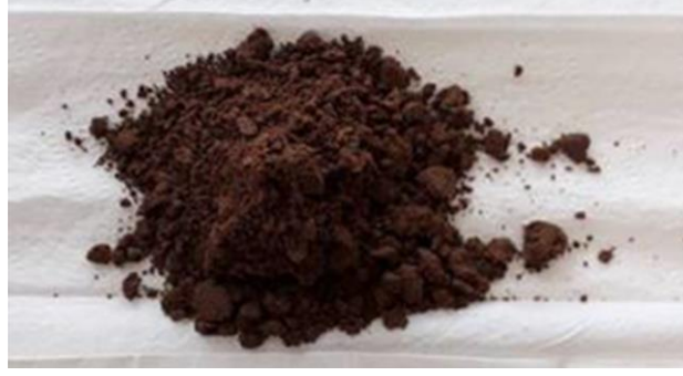
Şekil 3.5. Deneylerde karışıma % 80 oranında STT, % 20 oranında reçine ilave edildiğinde kompozit harçların numunelerinde yapısal bütünlük sağlamaması
