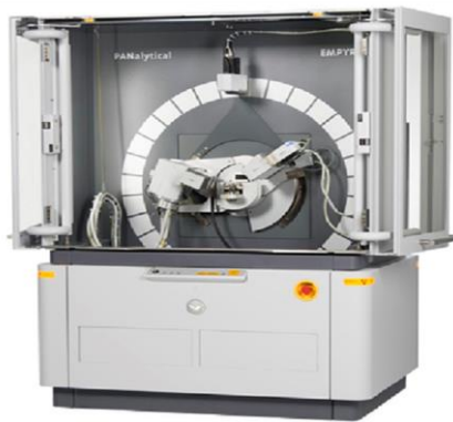
Şekil 3.17. STT'nin krisital yapısının (Panalytical Empyrean) analizinde kullanılan deney seti (URL, 7)
