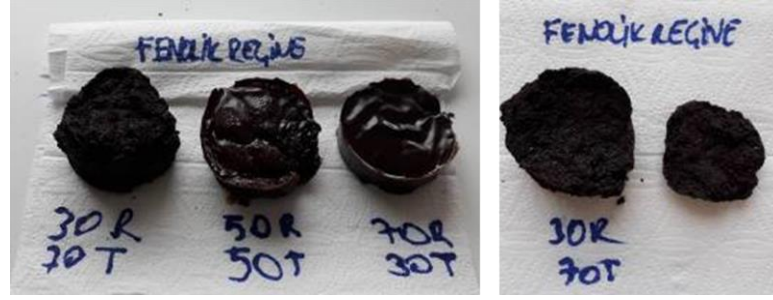
Şekil 3.4. STT'nin içerisine FR % 30, % 50 ve % 70 oranında ilave edilmiş numunelerde yapısal bütünlük özelliği göstermemesi
