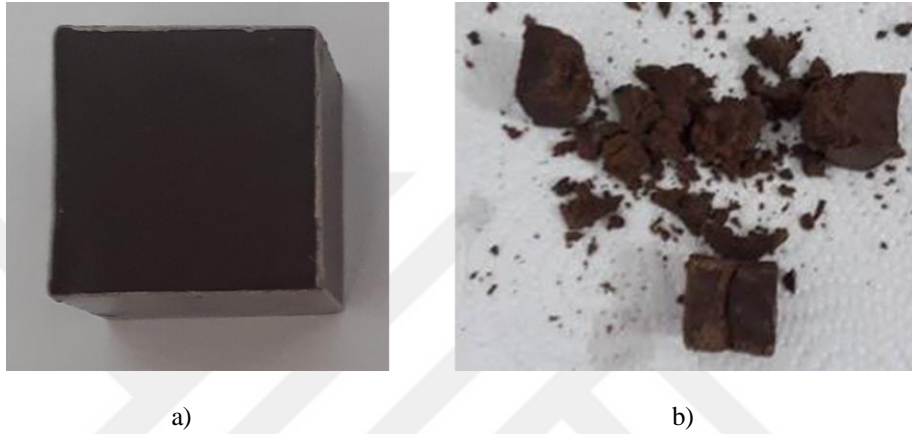
Şekil 3.11. (a) % 75 oranında STT, % 25 oranında ER ilave edildiğinde kompozit harç numunesinde yapısal bütünlük sağlanması, (b) % 75 oranında STT, % 25 oranında PR ilave edildiğinde kompozit harç numunesinde parçalanma görülmesi
