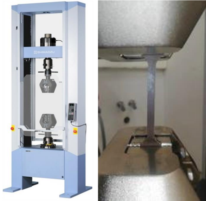
Şekil 3.24. SHIMADZU AGS-X cihazı ile numunelere çekme testinin yapılması
