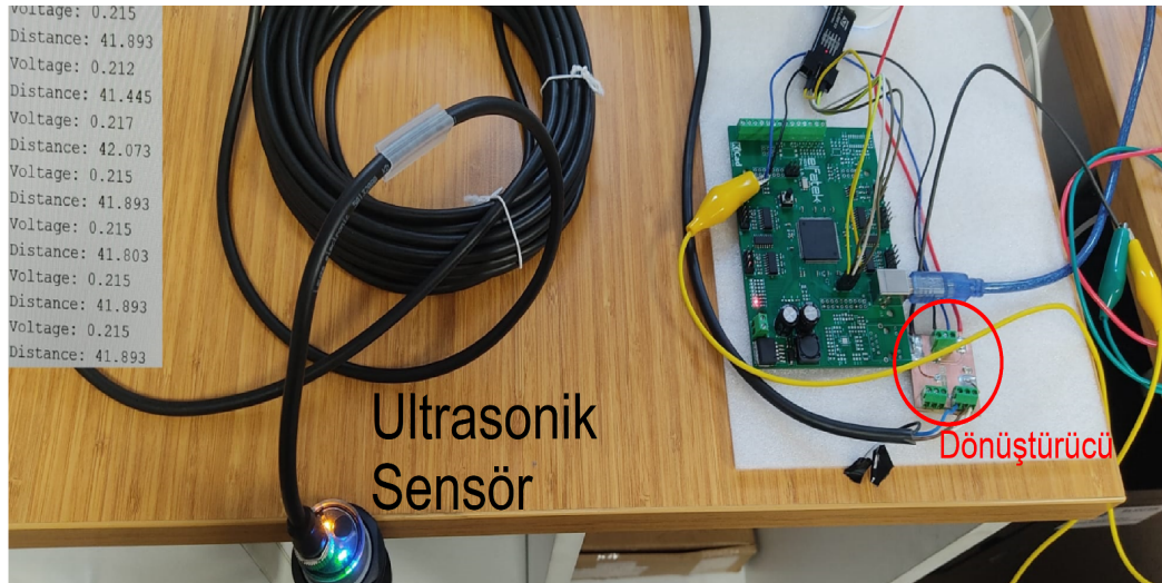
Şekil 3.32. Harici Modül İle Ultrasonik Sensör Okuma
