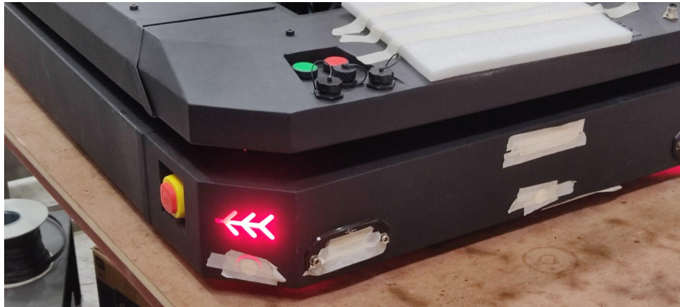
Şekil 3.30. Sinyal Lambası Anahtarlama Testi
