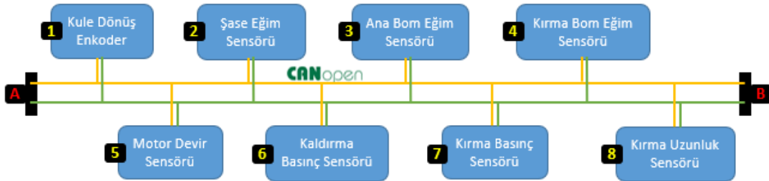
Şekil 3.4. Sensör yerleşim topolojisi
