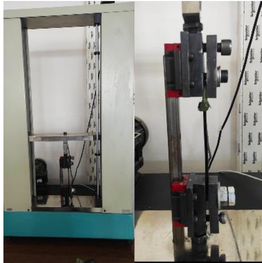
Şekil 3.17. Çekme testi cihazı ve çekme testi yapılan numune görüntüsü
