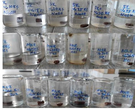
Şekil 3.21. Kompozit numunelerin asidik, bazik ve tuz çözeltileri içerisinde bekletilme görüntüleri
