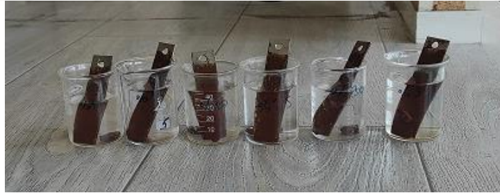
Şekil 3.23. Kaplanmış metal numunelerin korozyon testi
