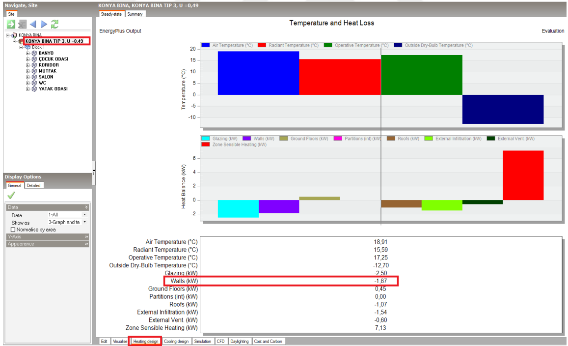
Şekil 3.59. Konya Tip 3, U= 0,49 \text{ W/m}^2\text{K} , Isıtma Tasarımı analiz sonucu (Yazar tarafından oluşturulmuştur)
