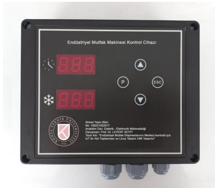
Şekil 4.2. Endüstriyel Mutfak Makinesi Kontrol Cihazı
