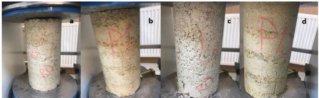
Şekil 3.7. Basınç Dayanım Testi a)R0 numunesi b)P1 numunesi c)R0 numunesi kırılmış hali d)P1 numunesi kırılmış hali
