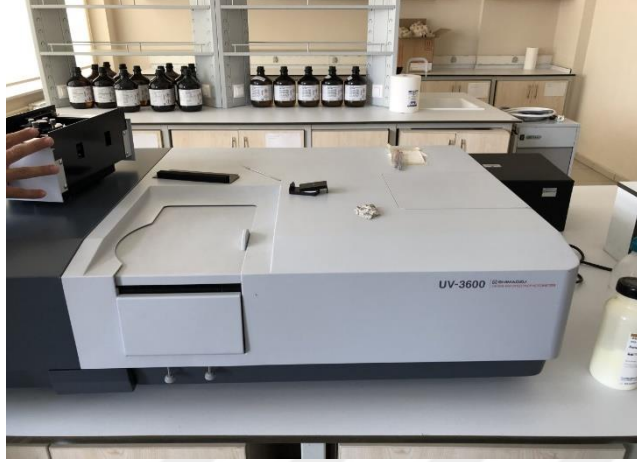
Şekil 3.13. Yansıtma özelliği belirleyen test cihazı spektrofotometre
