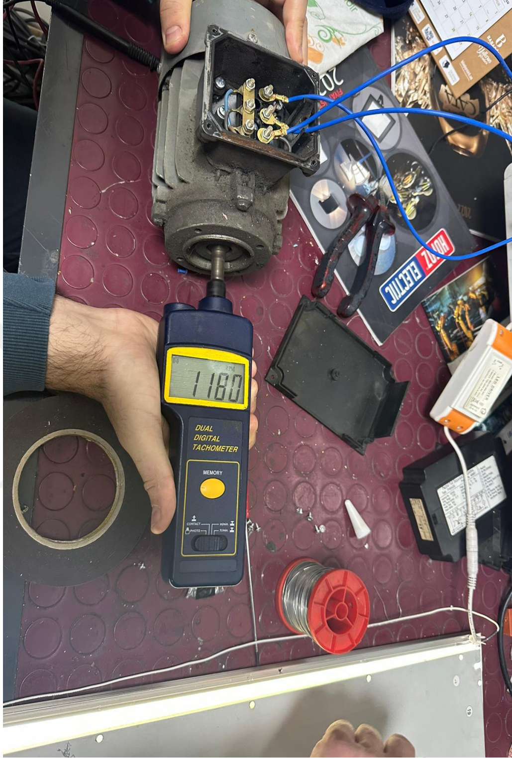
Şekil 4.3. Hız ölçümünde kullanılan takometre
