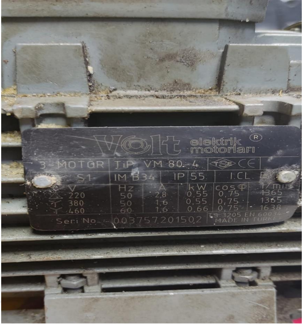
Şekil 4.2. Kullanılan asenkron motorun motor etiketi
