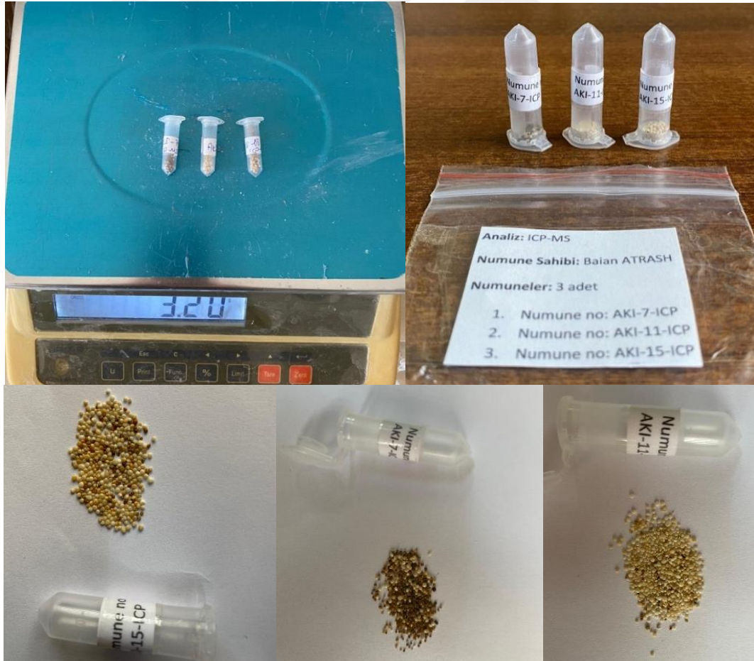
Şekil 3.5. Doğu Anadolu Yüksek Teknoloji Uygulama ve Araştırma Merkezi'nde (DAYTAM) gerçekleştirilen ICP-MS analizleri için hazırlanmış foraminifer kavkı numuneleri
