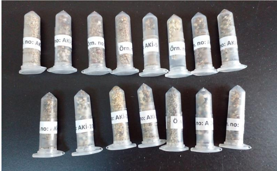
Şekil 3.3. Bentik foraminiferlerin tür tayini için kullanılmak üzere kilitli kapaklı eppendorf mikrosantrifüj tüplerinde hazırlanan sediment numuneleri
