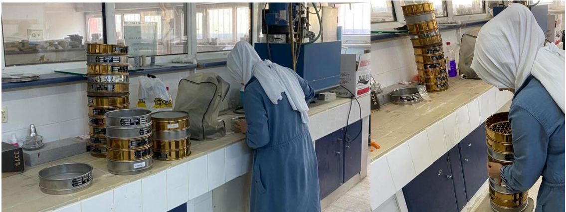
Şekil 3.6. Konya Teknik Üniversitesi laboratuvarlarında gerçekleştirilen deniz tabanı sedimentlerinin tane boyu dağılımı analizleri
