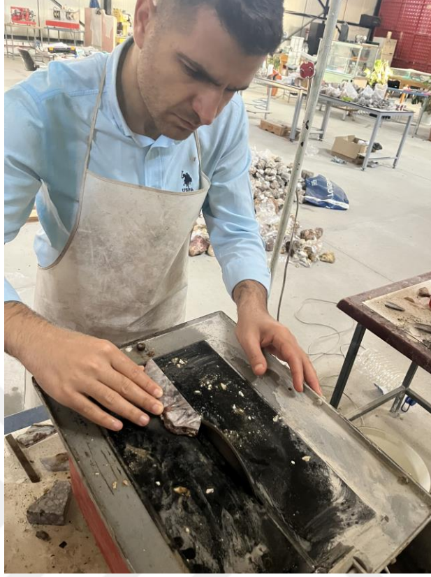
Şekil 26 Elmas taşlı ve su soğutma sistemli ince dilimleme aleti
