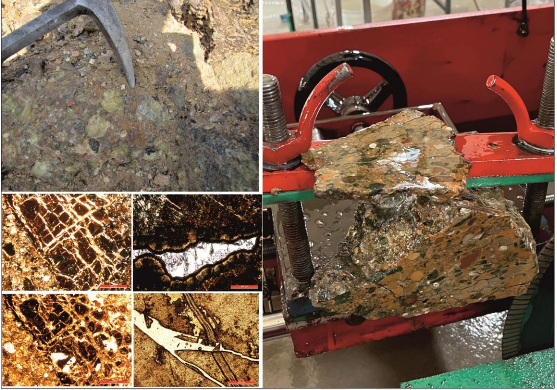
Şekil 12. Gayzerit oluşumu saha görünümü, büyük kesme makinası kesimi ve incekesit fotoğrafları
