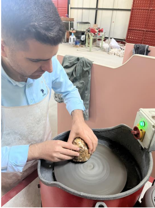
Şekil 28. Yatay lap aşındırma makinesinde parlatılan opal
