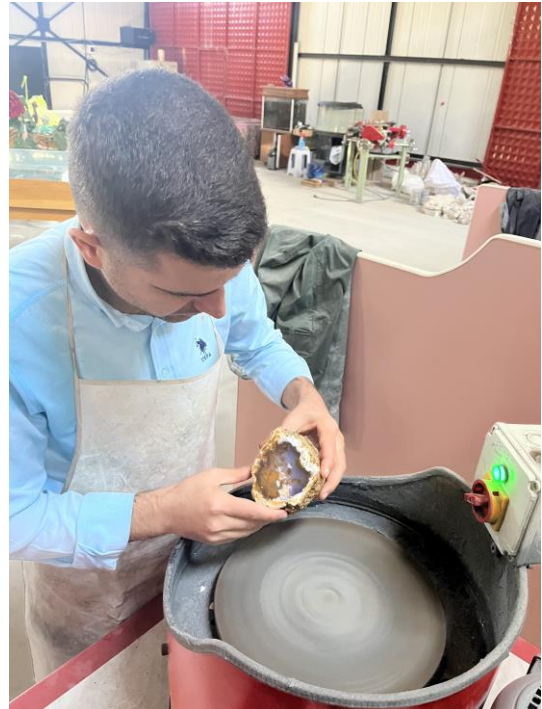
Şekil 28. Yatay lap aşındırma makinesinde parlatılan opal
