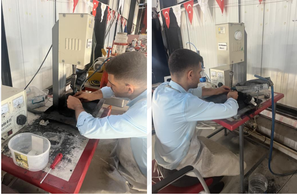
Şekil 29. Ultrasonik delme makinesi ile delme işlemi
