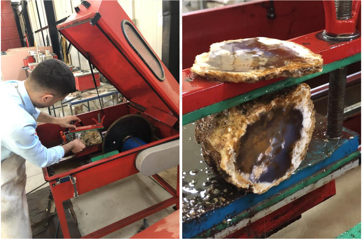
Şekil 25. Yağ soğutma sistemli yaklaşık 45 cm elmas uçlu kesme taşı büyük kesim ve oluşan dilim makinası ve kesilen opal
