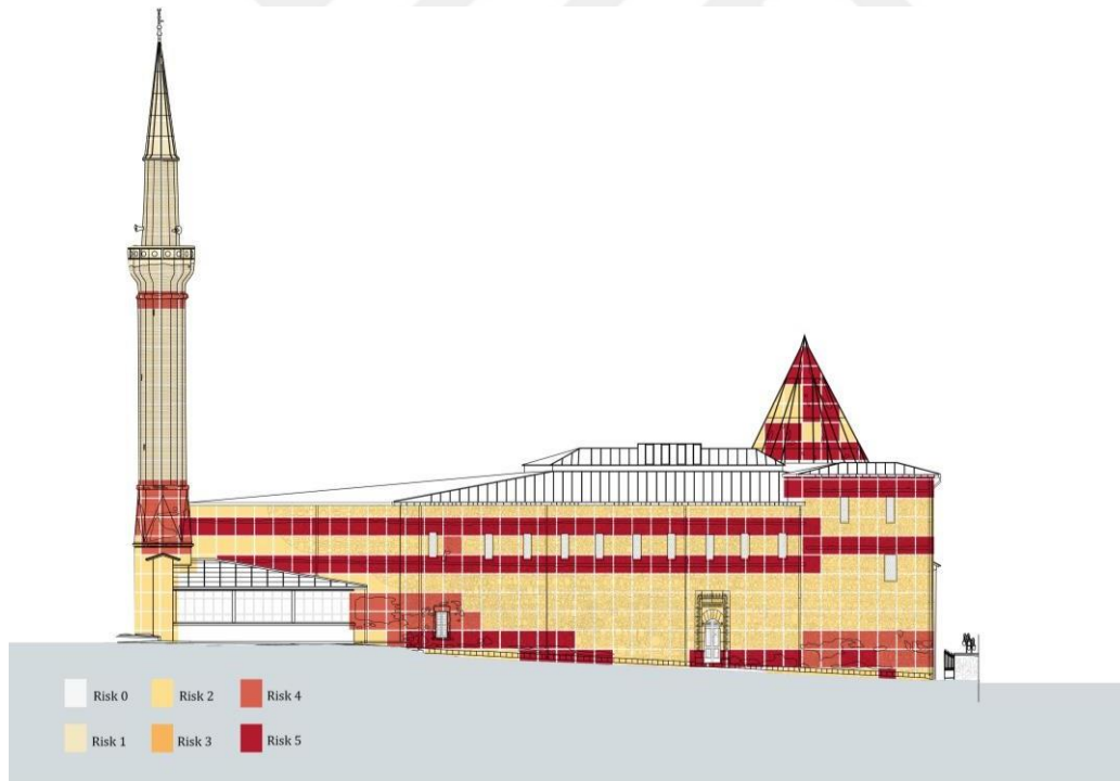
Şekil 4.66. Eşrefoğlu Cami kuzey cephesi risk haritası (VGM arşivden düzenlenerek)
