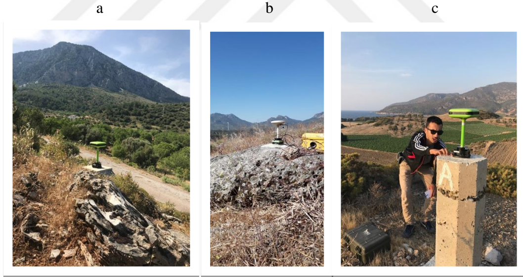
Şekil 3.21. a; Kayada Burç şeklinde tesisi yapılan KD02 noktası, b; Kayada Burç şeklinde tesisi yapılan KD03 noktası, c; KD10 olarak isimlendirilen mevcut pilye yapısı.
