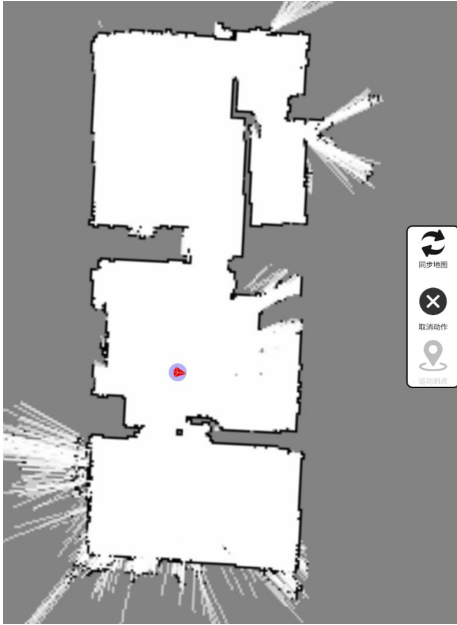
EK-12 Geleneksel dönem 11 numaralı ev 1.kat için lidarla elde edilen harita
