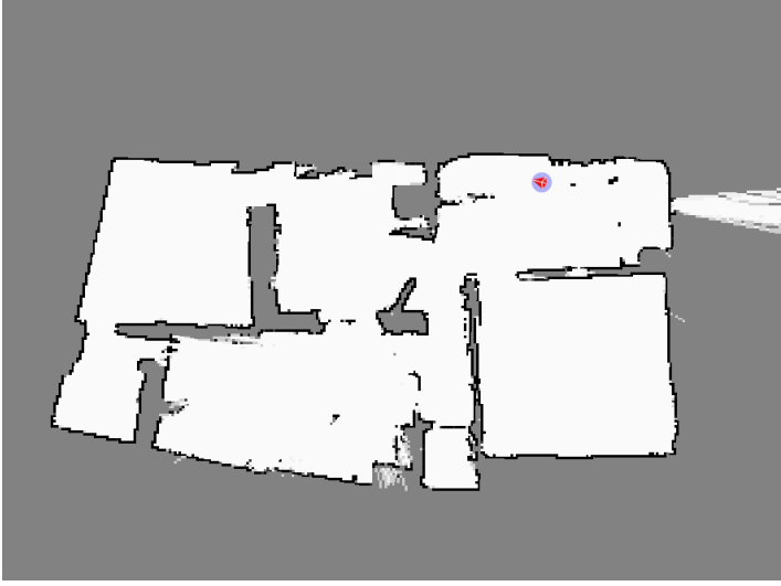
EK-35 Geiş dnemi 15 numaralı ev zemin kat iin lidarla elde edilen harita
