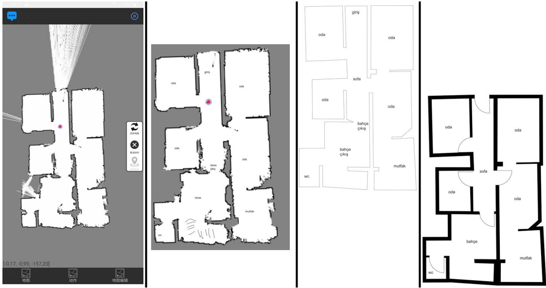
Şekil 4.4. Elde edilen haritanın CAD programlarına aktarılması
