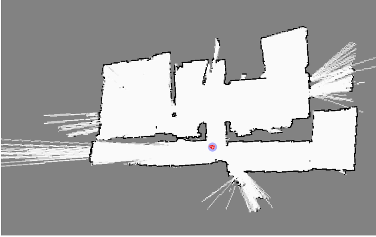
EK-42 Modern dönem 4 numaralı ev 1. kat için lidarla elde edilen harita
