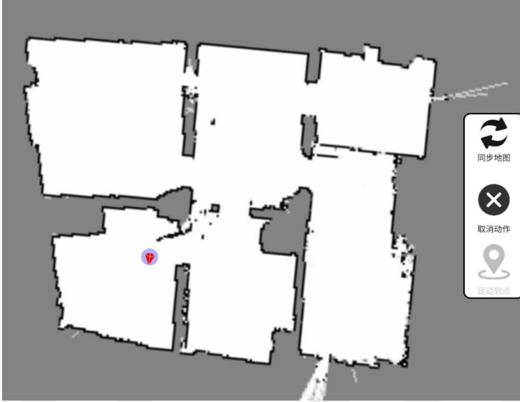
EK-21 Geçiş dönemi 5 numaralı ev zemin kat için lidarla elde edilen harita
