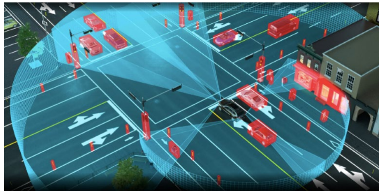
Şekil 4.2. Otonom araçlarda Lidar sensörün çevreyi algılaması (URL-6)
