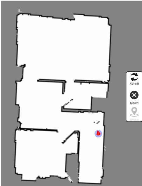
EK-12 Geleneksel dönem 11 numaralı ev 1.kat için lidarla elde edilen harita
