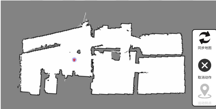
EK-18 Geçiş dönemi 3 numaralı ev zemin kat için lidarla elde edilen harita
