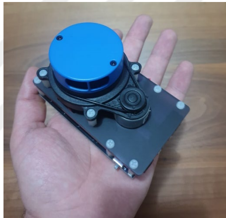
Şekil 3.1. Çalışmada kullanılan Lidar sensör
