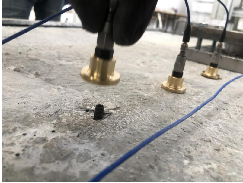
Şekil 3.38. İvmeölçerlerin numuneye yerleşimi
