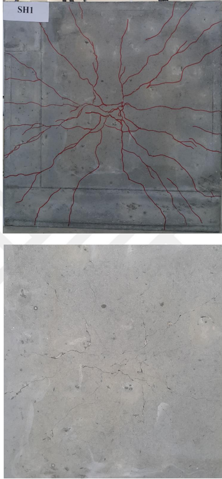
Şekil 4.59. SH1 numunesinde oluşan çatlak dağılımı
