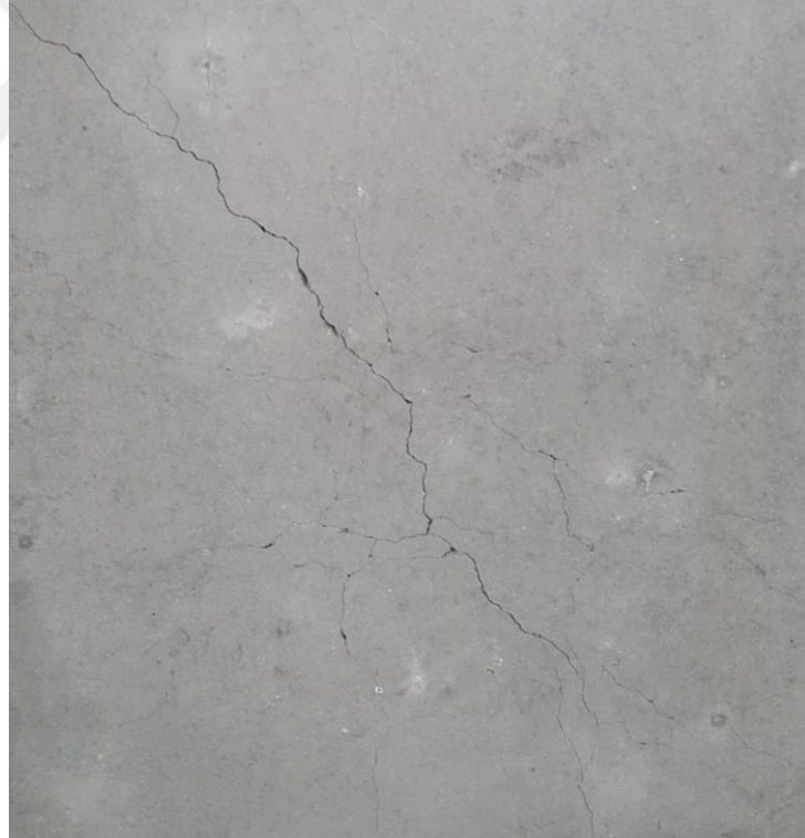
Şekil 4.67. SH3 numunesinde oluşan çatlak dağılımı
