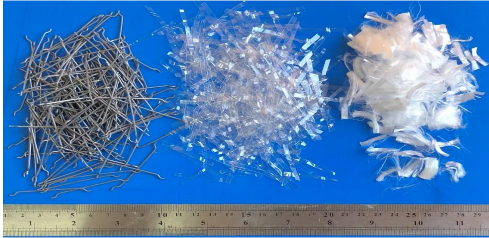
Şekil 3.8. Çalışmada kullanılan liflerin görünümü; solda çelik lif, ortada polipropilen lif, sağda PET lif
