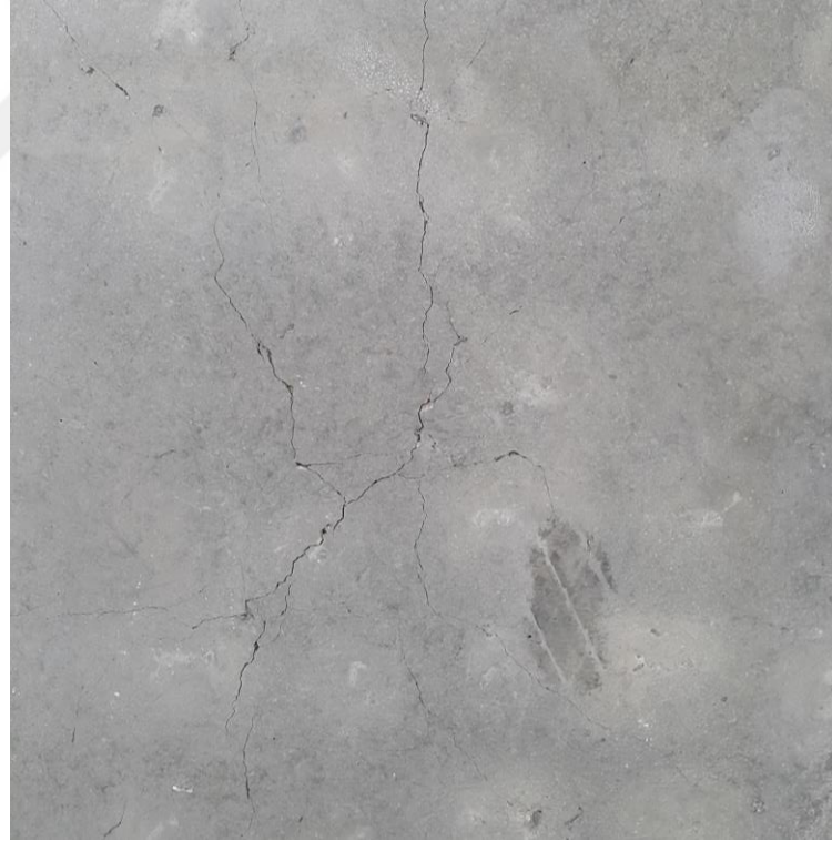
Şekil 4.71. SH4 numunesinde oluşan çatlak dağılımı
