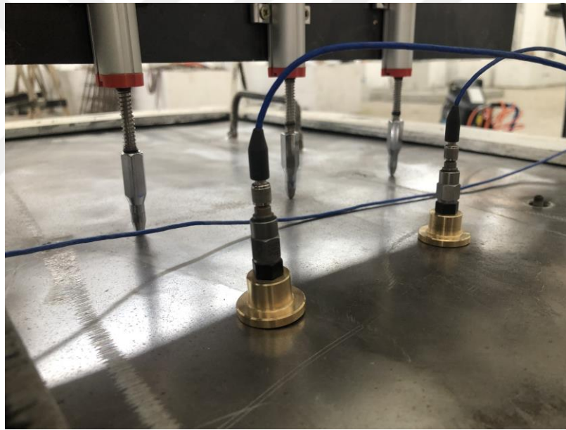
Şekil 3.39. Üst yüzeyinde çelik levha bulunan betonarme plaklarda ivmeölçer montajı
