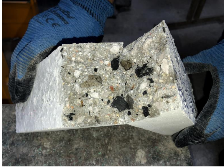
Şekil 4.20. Çatlak yolundaki kauçuk partiküllerinin sıyrılması
