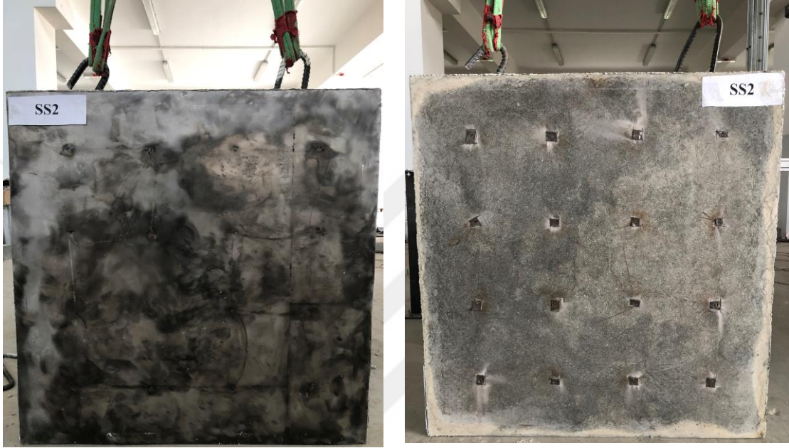
Şekil 3.48. SS2 plaktan çelik levhanın çıkarılması
