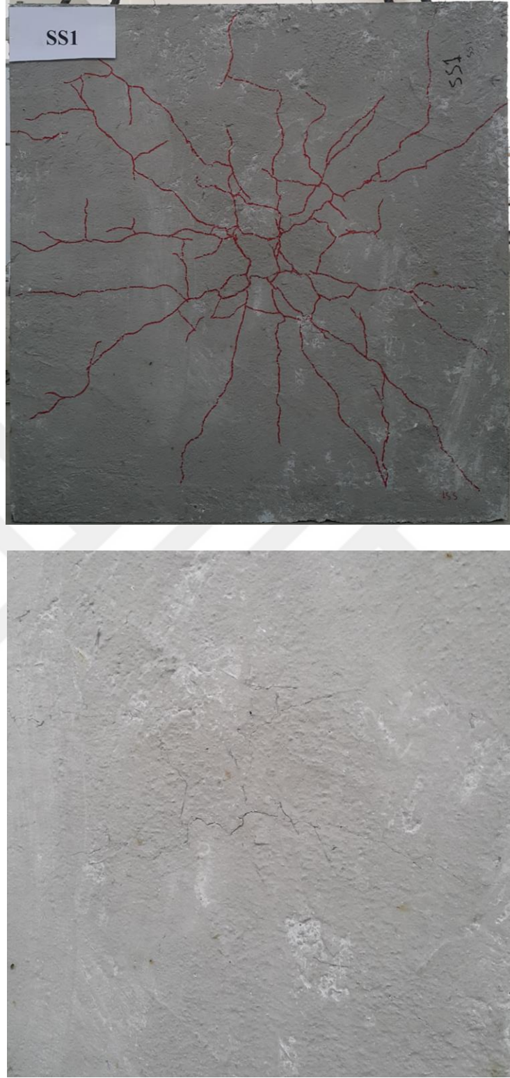
Şekil 4.75. SS1 numunesinde oluşan çatlak dağılımı
