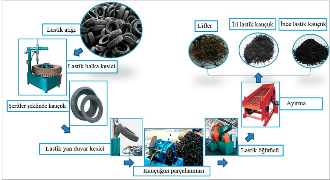
Şekil 1.5. Betonda kullanılacak atık lastik kauçuğun hazırlanma süreci (Mhaya ve ark., 2021)
