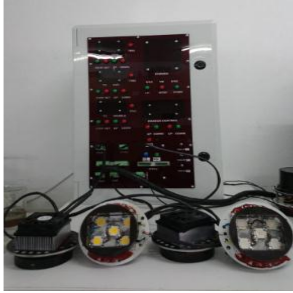
Şekil 3.9. Fotokataliz reaktör ışık kaynakları ve kontrol paneli
