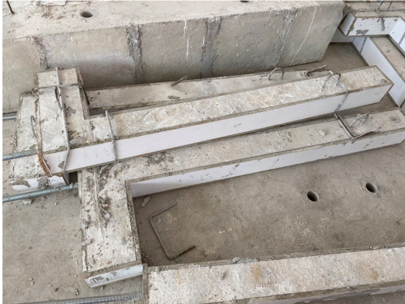
Şekil 3.20 Üretilen kolon numunelerinin laboratuvarda istiflenmesi
