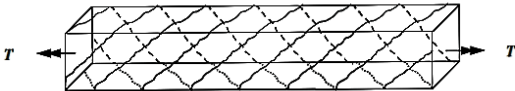
Şekil 1.2 Burulmada kesme çatlakları (Ersoy ve ark., 2019)
