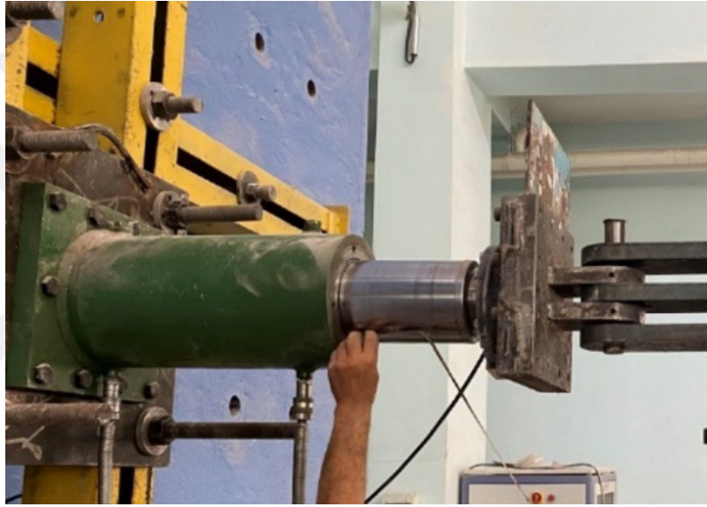
Şekil 3.23 Kolon ve yükün birlikte hareketini sağlayan çelik mafsallı birleşim
