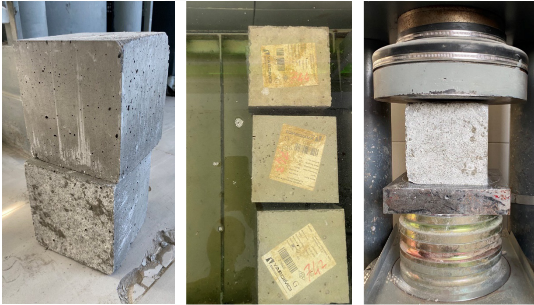
Şekil 3.8 Betondan alınan küp numunelerin kürü ve basınç testleri
