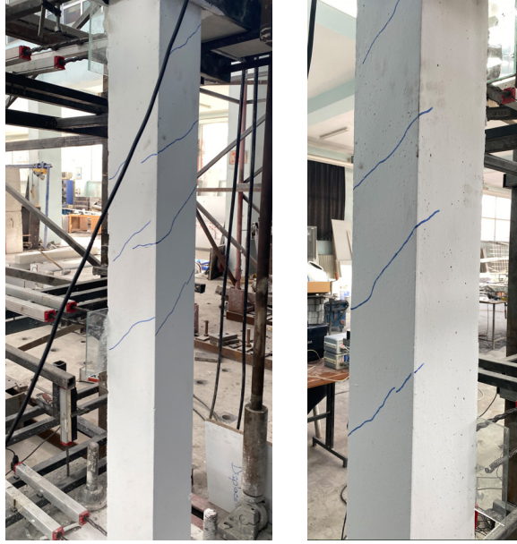
Şekil 4.26 SN-2 numunesinde meydana gelen ilk çatlaklar
