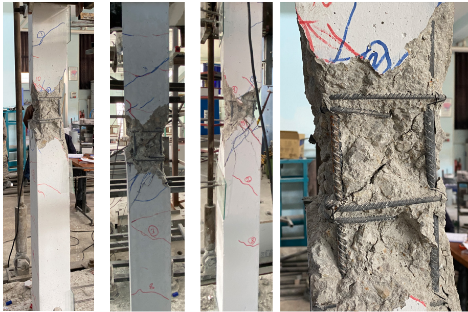
Şekil 4.54 SN-4 numunesinin maksimum burulma kapasitesinde hasar durumu
