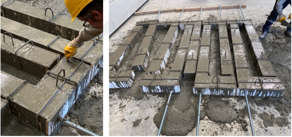
Şekil 3.17 Beton Dökümü Yapılan numunelerin masterlanması ve son durumu
