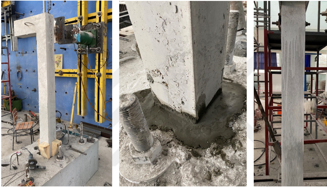
Şekil 3.21 Temel ve kolonun birleştirilmesi, grout harcı birleşimi, numunelerin boyanması
