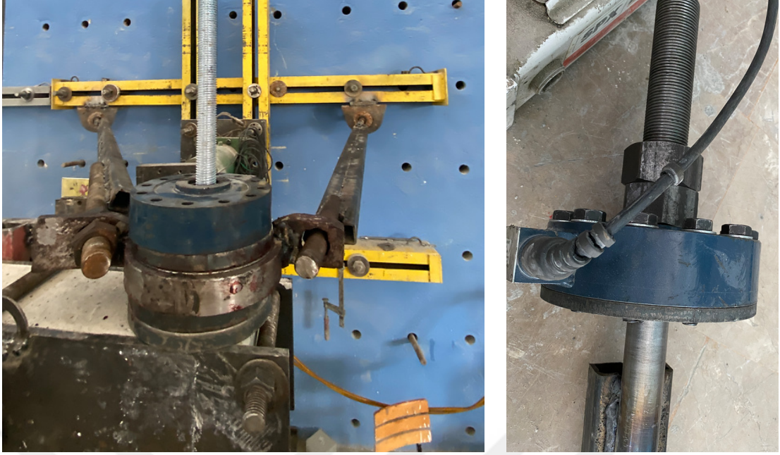
Şekil 3.28 Kolonda gijonun tutulması ve eğilmenin engellenmesi
