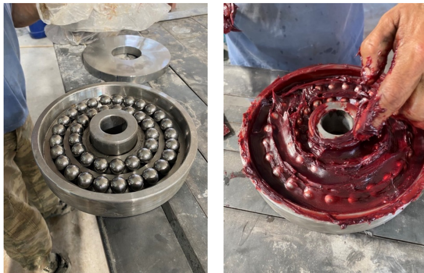
Şekil 3.25 Döner mafsal sistemi ve gres yağı uygulaması
