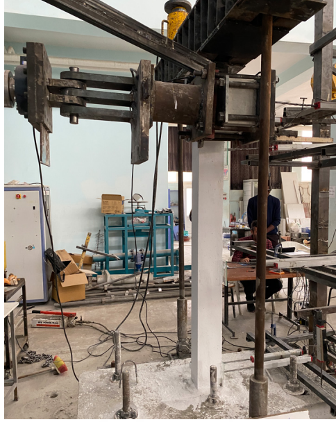
Şekil 4.12 SN-1 numunesinin deney düzeneğinde görünüşü
