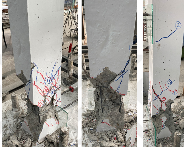
Şekil 4.42 SN-3 numunesinin nihai durumda hasar durumu
