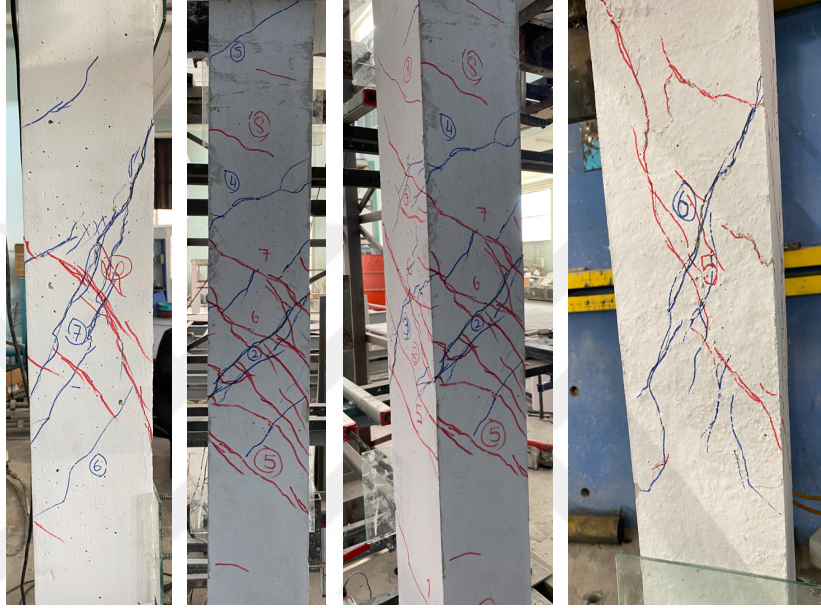
Şekil 4.67 SN-5 numunesinin maksimum burulma kapasitesinde hasar durumu
