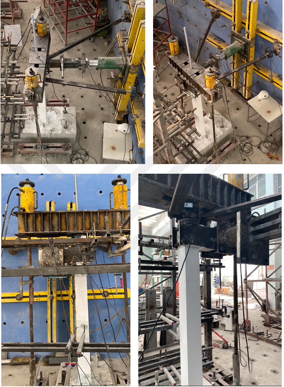
Şekil 3.29 Aksenal yük-burulma yüklemesi deney düzeneği
