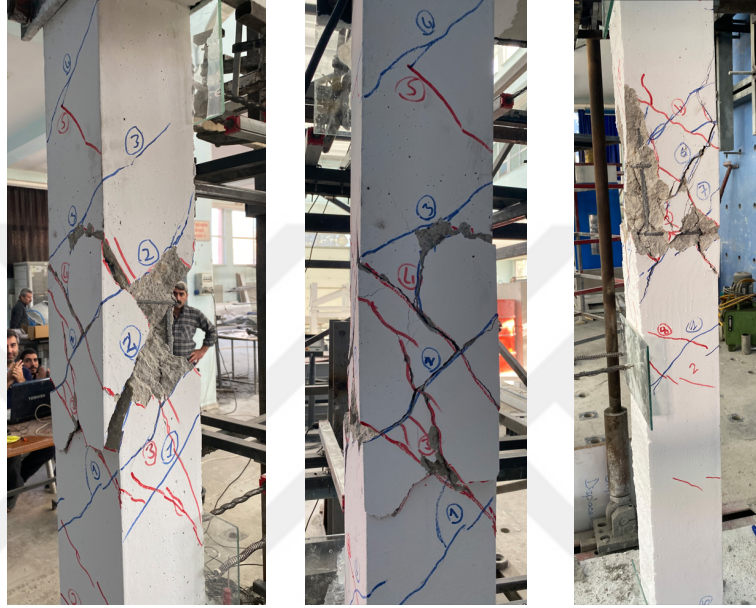
Şekil 4.28 SN-2 numunesinin maksimum burulma kapasitesinde hasar durumu
