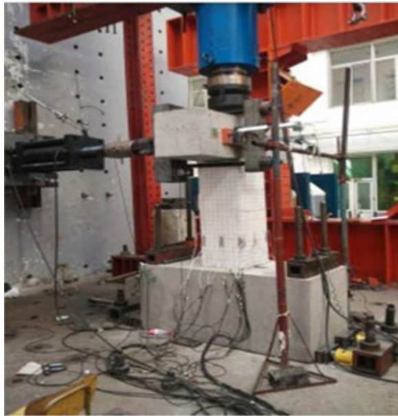
Şekil 2.4 Burulma deney düzeneği (Chen ve ark., 2018)
