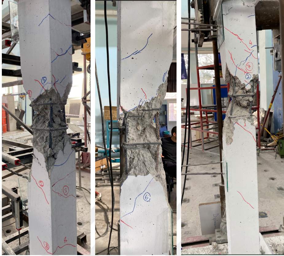
Şekil 4.95 Numunelerde hasar gören bölgelerin karşılaştırılması
