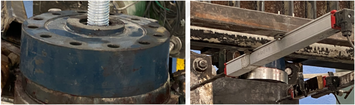
Şekil 3.31 Yük hücresi ve potansiyometrik cetveller
