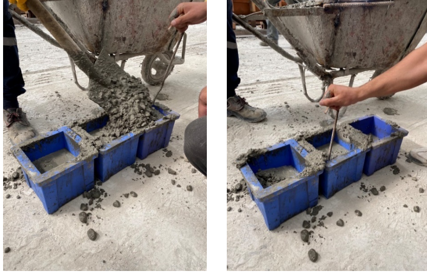
Şekil 3.7 Basınç testi için numune alınması
