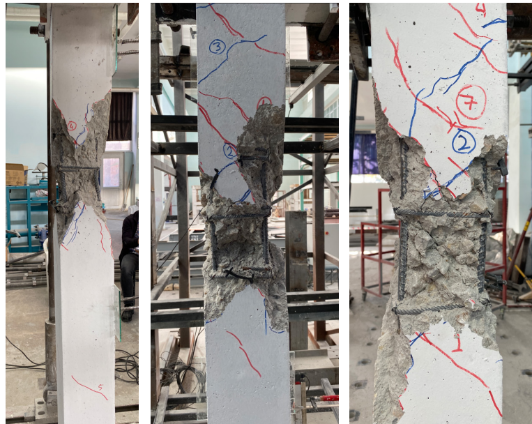
Şekil 4.79 SN-6 numunesinin maksimum burulma kapasitesinde hasar durumu
