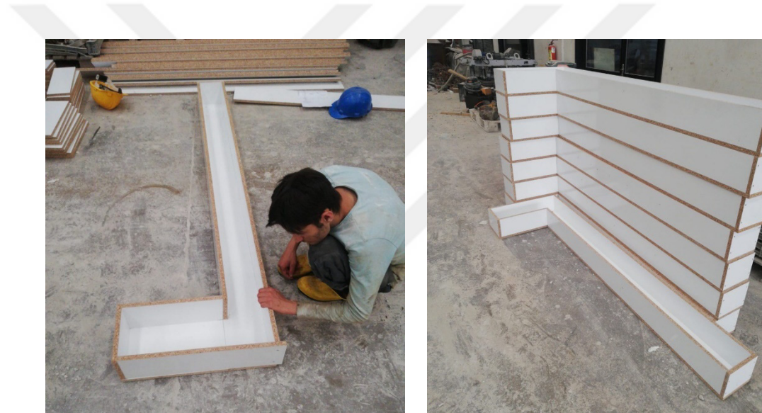
Şekil 3.10 Deney kalıplarının hazırlanması
