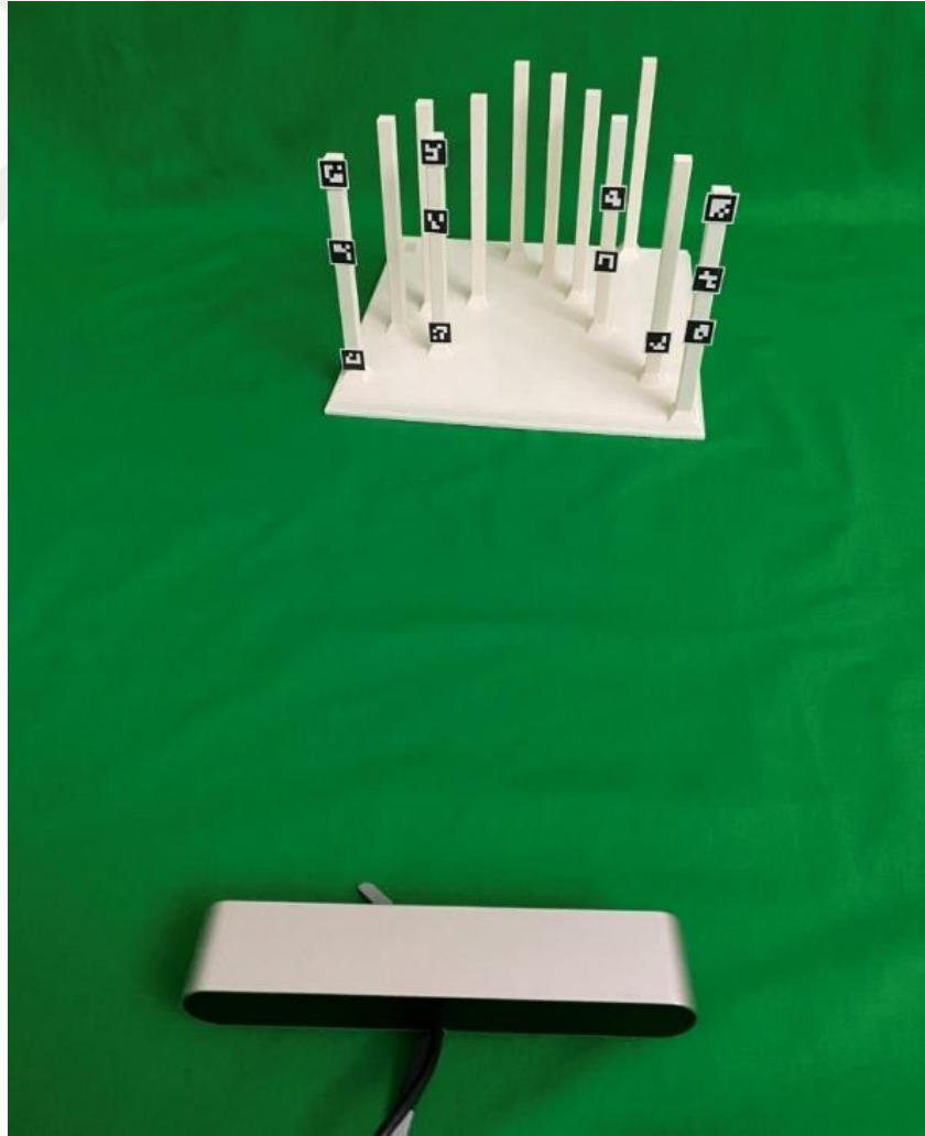
Şekil 4.5 – Farklı Derinliklere Sahip Test Düzeneđi ve Zed Kamera
