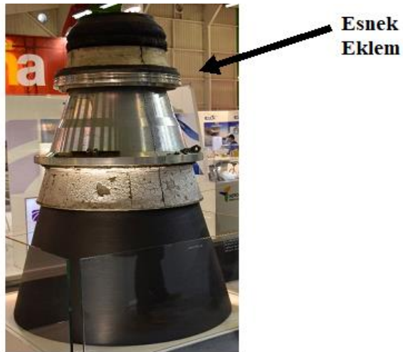
Şekil 1.3 – Esnek Eklemli Katı Yakıtlı Roket Motoru (Vega Rocket Nozzle of the Zefiro 23, 2015)
