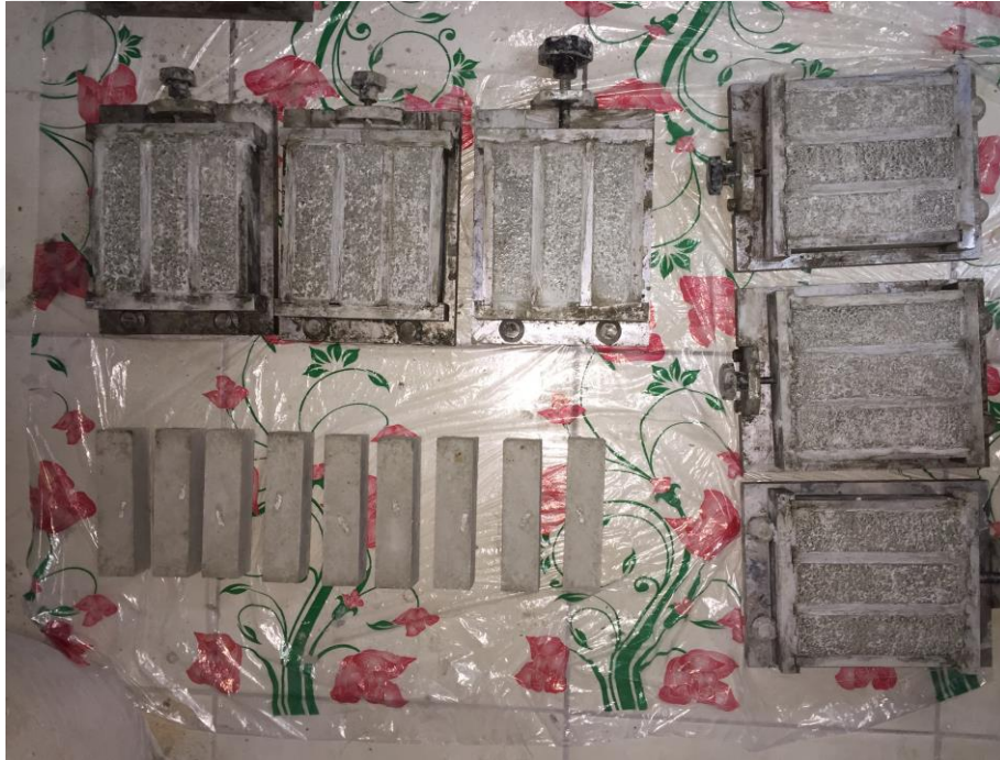
Şekil 4.2. 24 saatin sonunda kalıplardan çıkarılan 40x40x160 mm boyutunda numuneler
