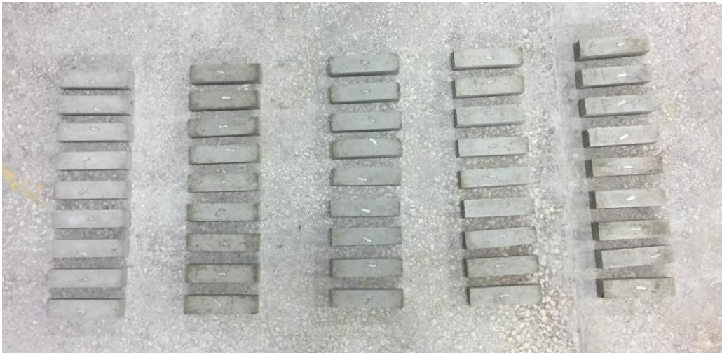
Şekil 4.4. Farklı serilerdeki 40x40x160 mm boyutundaki numunelerin bir kısmı
