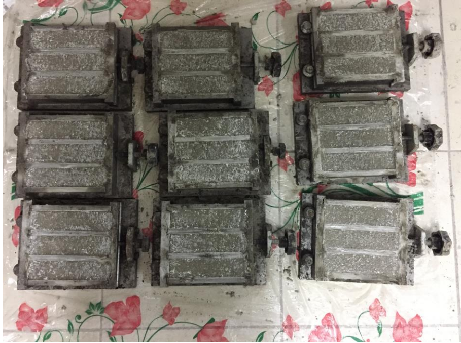
Şekil 4.1. Farklı serilerdeki 40x40x160 mm boyutunda numunelerin kalıplara yerleştirilmesi
