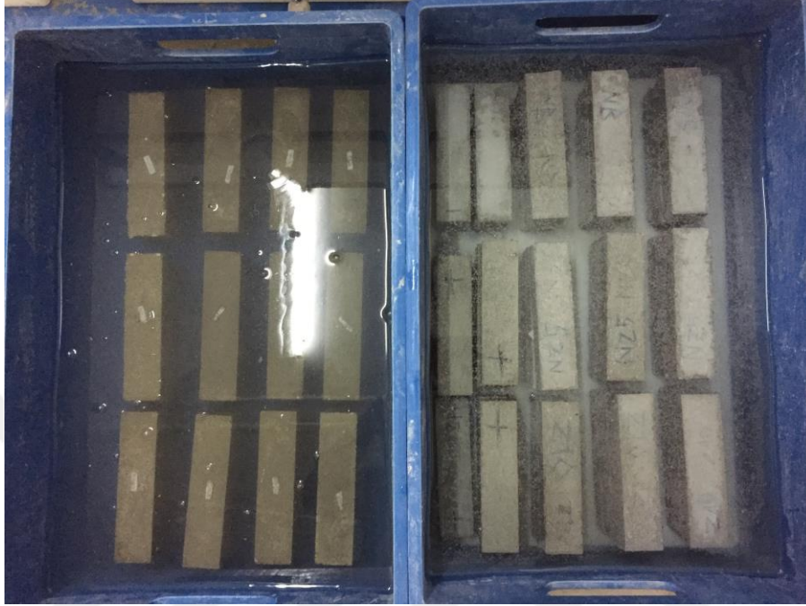
Şekil 4.5. 40x40x160 mm boyutunda numunelerin kür havuzundaki görüntüsü
