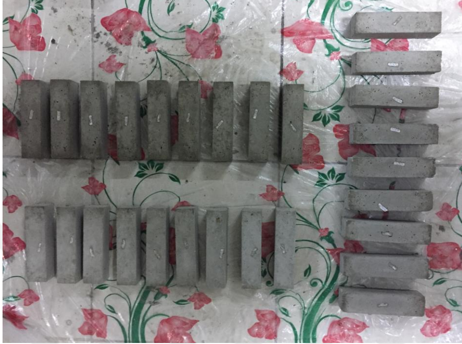
Şekil 4.3. Farklı serilerdeki 40x40x160 mm boyutundaki numunelerin bir kısmı
