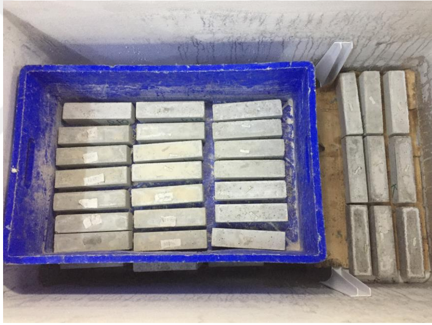
Şekil 4.9. 40x40x160 mm boyutundaki numunelerin donma esnasındaki görüntüsü
