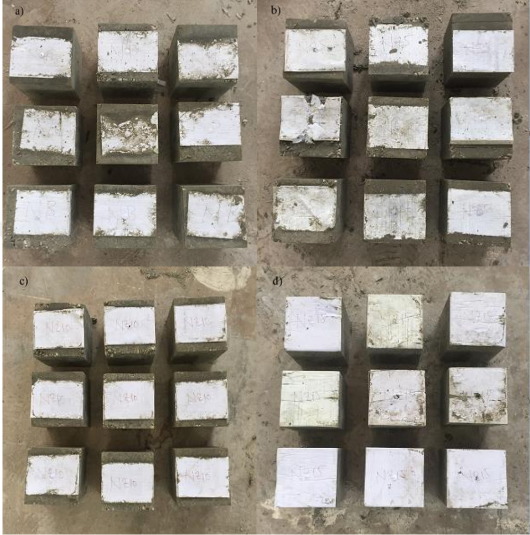
Şekil 4.7. 24 saatin sonunda kalıplardan çıkarılan 150x150x150 mm boyutunda a)NB kodlu numuneler b)NZ5 kodlu numuneler c)NZ10 kodlu numuneler d)NZ15 kodlu numuneler
