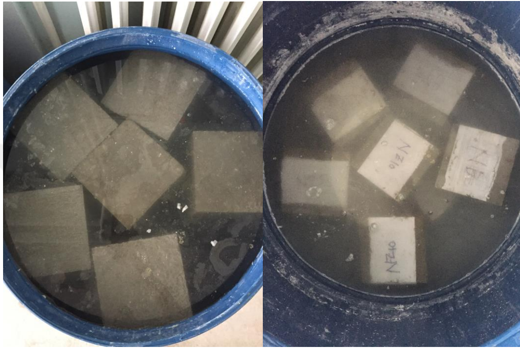
Şekil 4.8. 150x150x150 mm boyutunda beton numunelerinin kür havuzundaki görüntüsü
