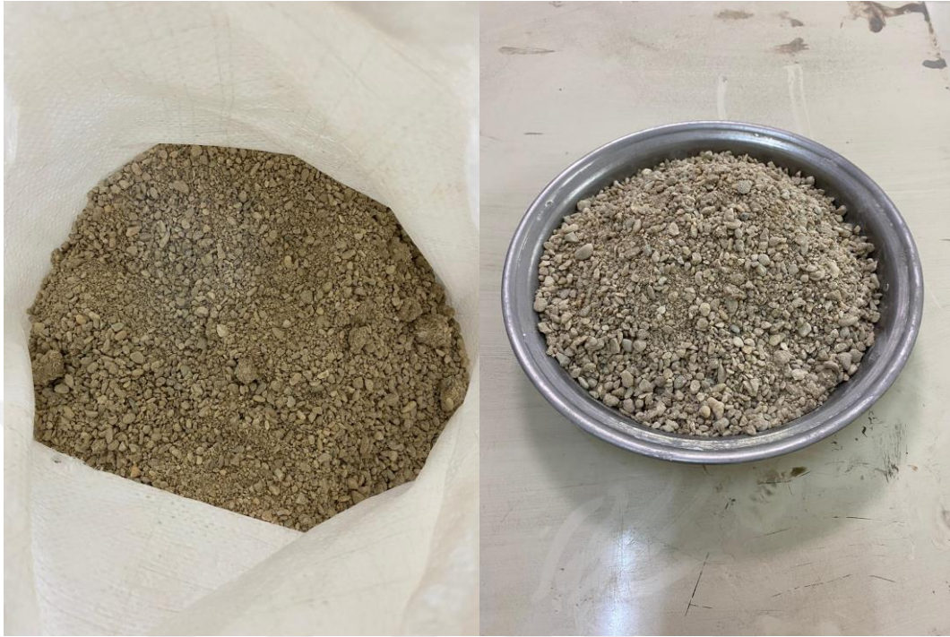
Şekil 3.5. Tane dağılımı 0-4 mm arasında olan dere kumunun görüntüsü
