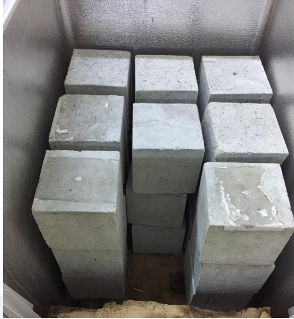
Şekil 4.10. 150x150x150 mm boyutundaki numunelerin donma esnasındaki görüntüsü
