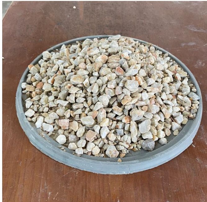
Şekil 3.3. Tane dağılımı 0-16 mm arasında olan iri ve ince agregat
