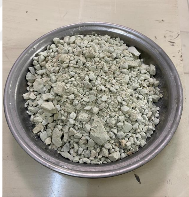
Şekil 3.6. D_{max}=10 mm zeolitin görüntüsü
