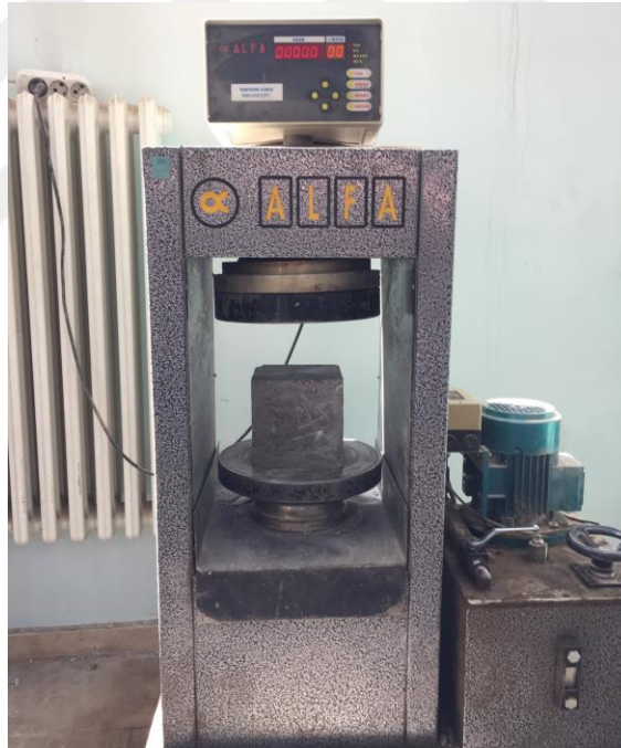
Şekil 4.13. 150x150x150 mm boyutunda numunelerin basınç dayanımı deneyinde kullanılan test cihazı
