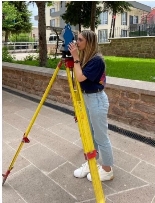
Şekil 3.47. Özel kâğıt hedef işaretlerinin koordinat okumaları lazer atımlı elektronik total station aleti ile gerçekleştirildi.
