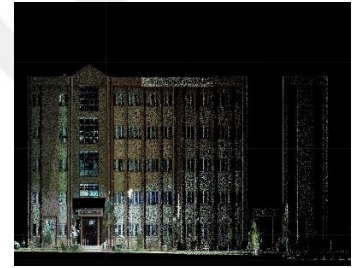
3 cm nokta yoğunluğundaki nokta bulutu
