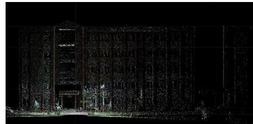
10 cm nokta yoğunluğundaki nokta bulutu
