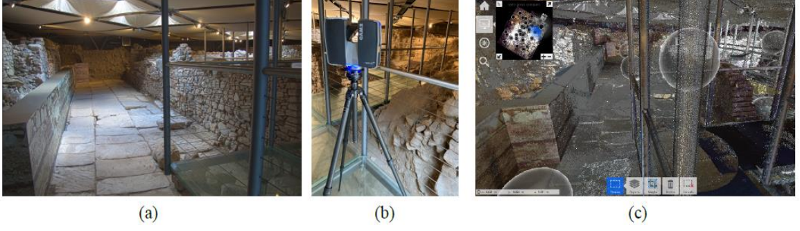
Şekil 3.19. (a) Piazza Italia'nın arkeolojik alanı; (b) lazer tarayıcı ile tarama; (c) 3B nokta bulutu (Giuffrida ve ark., 2022).
