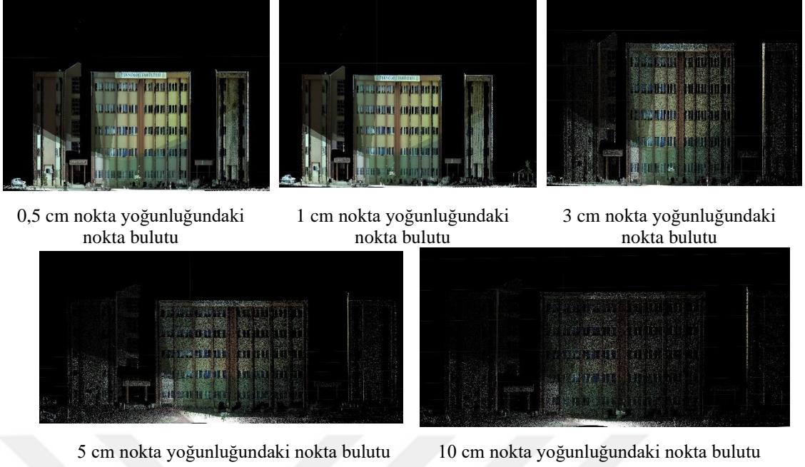
Şekil 3.51. Teknoloji fakültesinin 2. tarama istasyonundan 0,5 cm, 1 cm, 3 cm, 5 cm ve 10 cm nokta yoğunluklarına sahip nokta bulutları.
