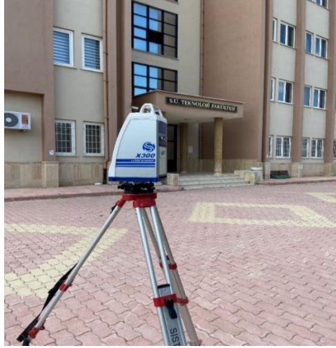
Şekil 3.49. Selçuk Üniversitesi Teknoloji Fakültesi tarama öncesi özel hedef işaretleri yerleştirildi ve ardışık taramalar gerçekleştirildi.
