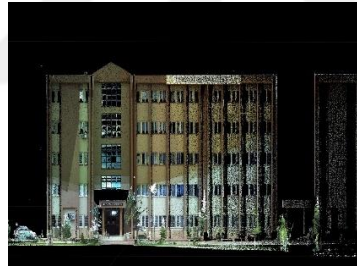
1 cm nokta yoğunluğundaki nokta bulutu
