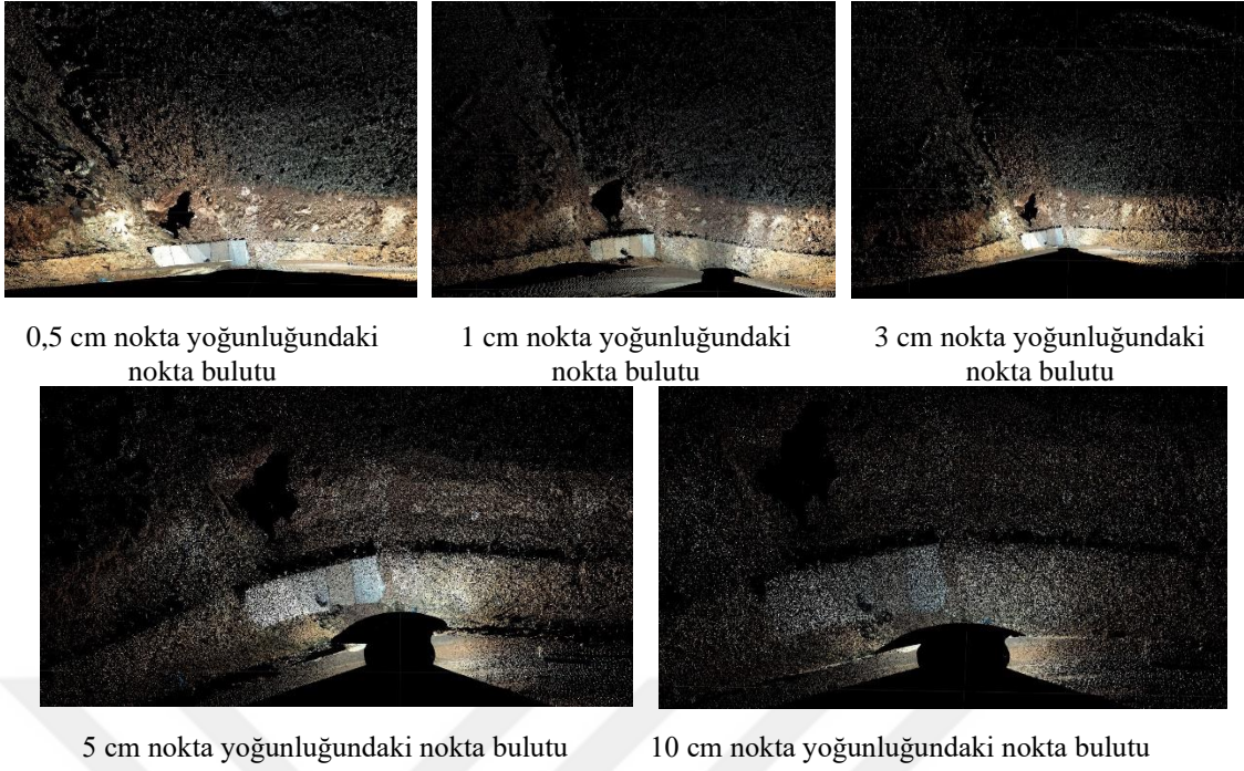
Şekil 3.54. Yol şevinin 1. tarama istasyonundan 0,5 cm, 1 cm, 3 cm, 5 cm ve 10 cm nokta yoğunluklarına sahip nokta bulutu.
