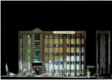
0,5 cm nokta yoğunluğundaki nokta bulutu
