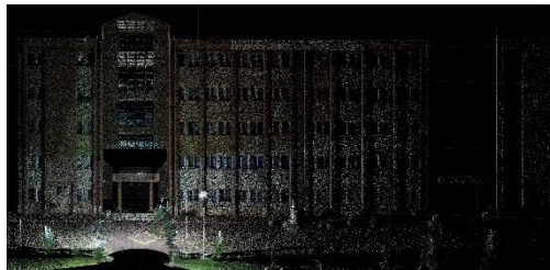
5 cm nokta yoğunluğundaki nokta bulutu
