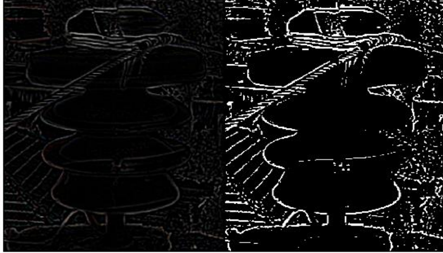
Şekil 0.10. Gri seviye izolatör görüntüsüne eşikleme işlemi uygulaması (Aslan, Y. ve ark., 2020)
