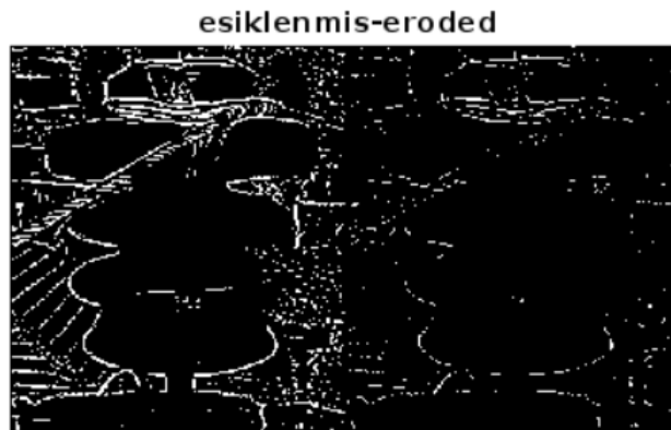
Şekil 0.14. Eşikleme yapılmış görüntüye aşındırma işleminin uygulaması (Aslan, Y. ve ark., 2020)
