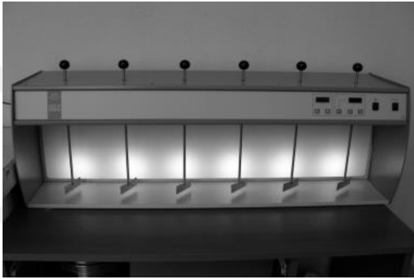
Şekil 2.3. Fenton prosesi düzeneđi, jar testi (Taşdemir 2010)
