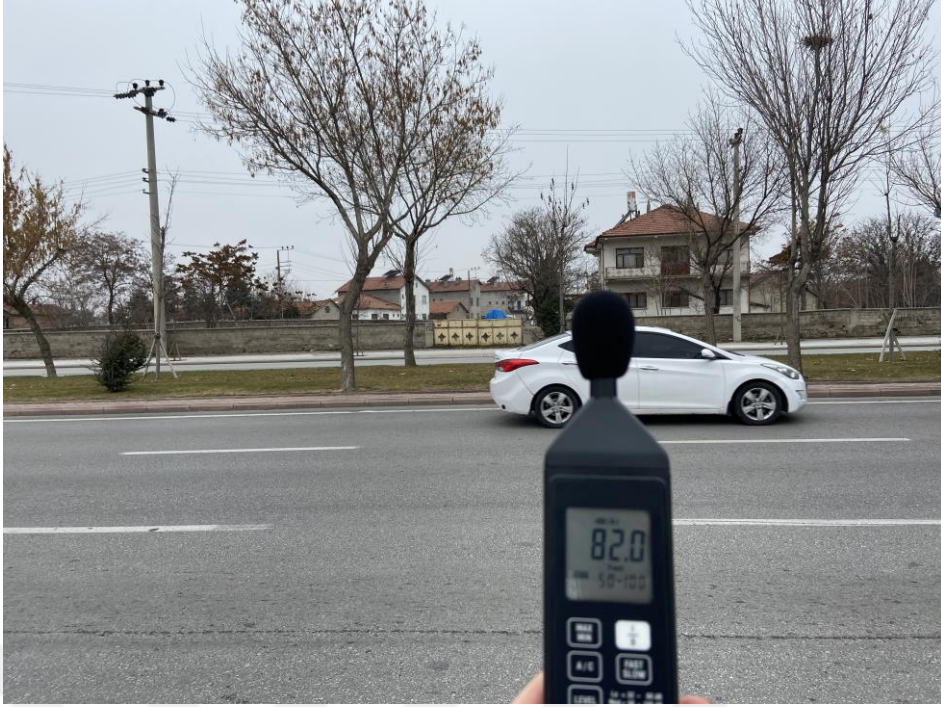
Şekil 4.5. Adana Çevre yolu caddesine ait otomobil geçişi esnasında çıkan gürültü ölçüm değeri
