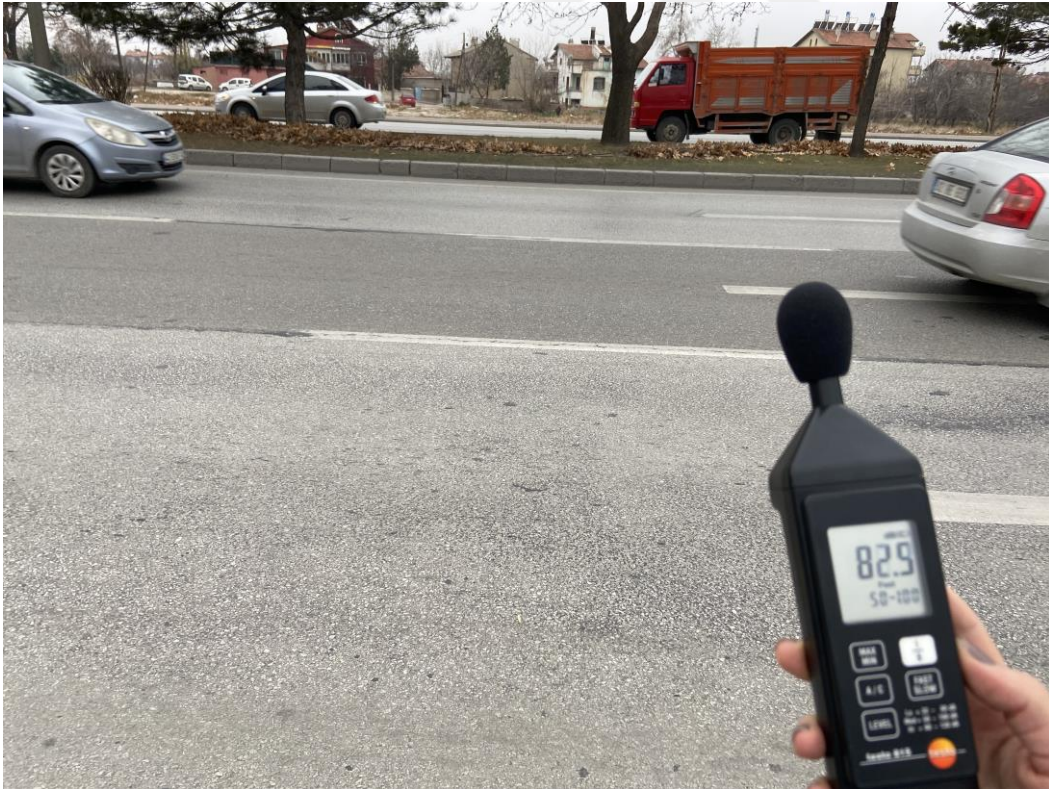
Şekil 4.6. Adana Çevre yolu caddesine ait otomobillerin geçişi esnasında çıkan gürültü ölçüm değeri
