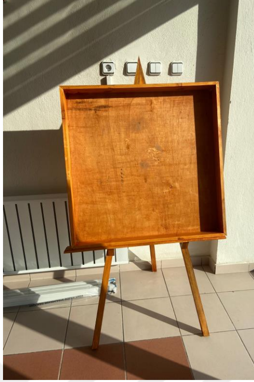
Şekil 3.3. Tasarlanan gürültü panelinin iskelet yapısı
