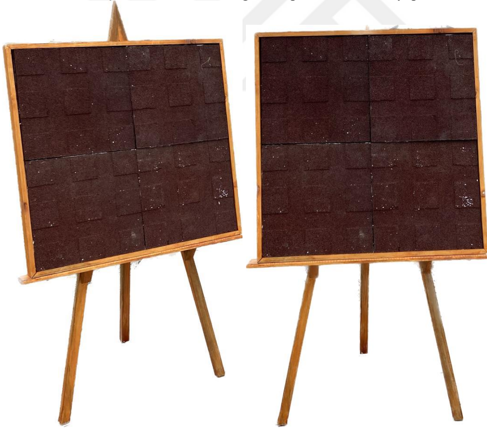
Şekil 3.4. Tasarlanan gürültü paneli (Taşıma kolaylığı açısından bu şekil tasarlanmıştır.)
