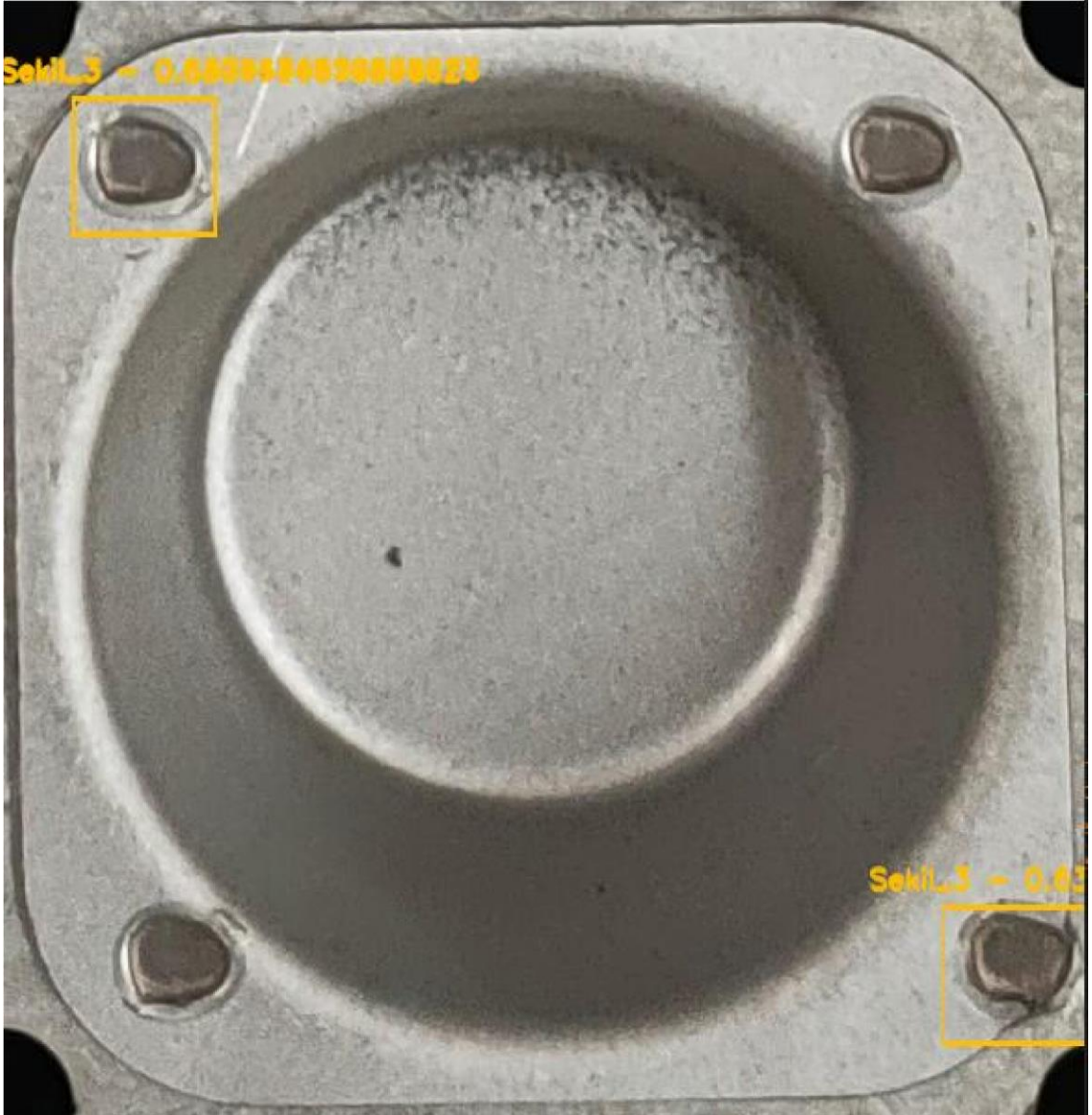
Şekil 4.7. Şablon Eşleştirme Algoritması Sonuçları
