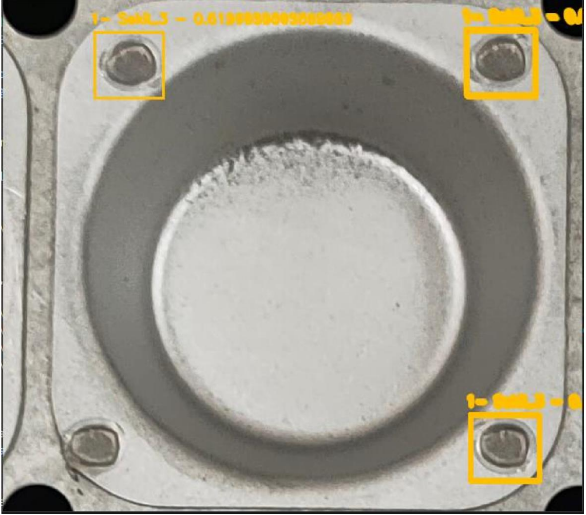
Şekil 4.6. Şablon Eşleştirme Algoritması Sonuçları
