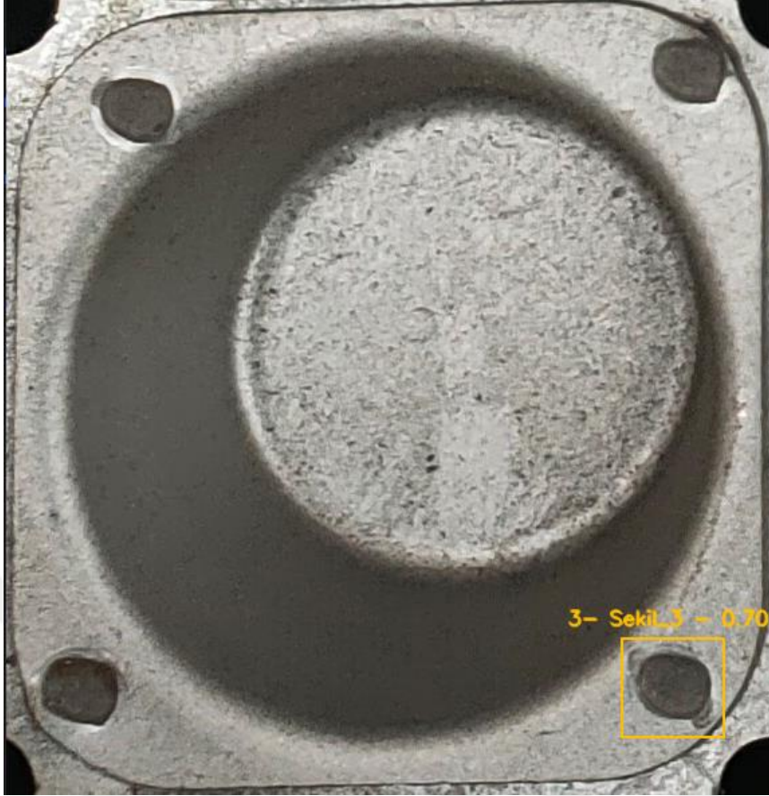
Şekil 4.2. Bozulmuş Kaynak Torç'unun Yaptığı Kaynak Görüntüsü
