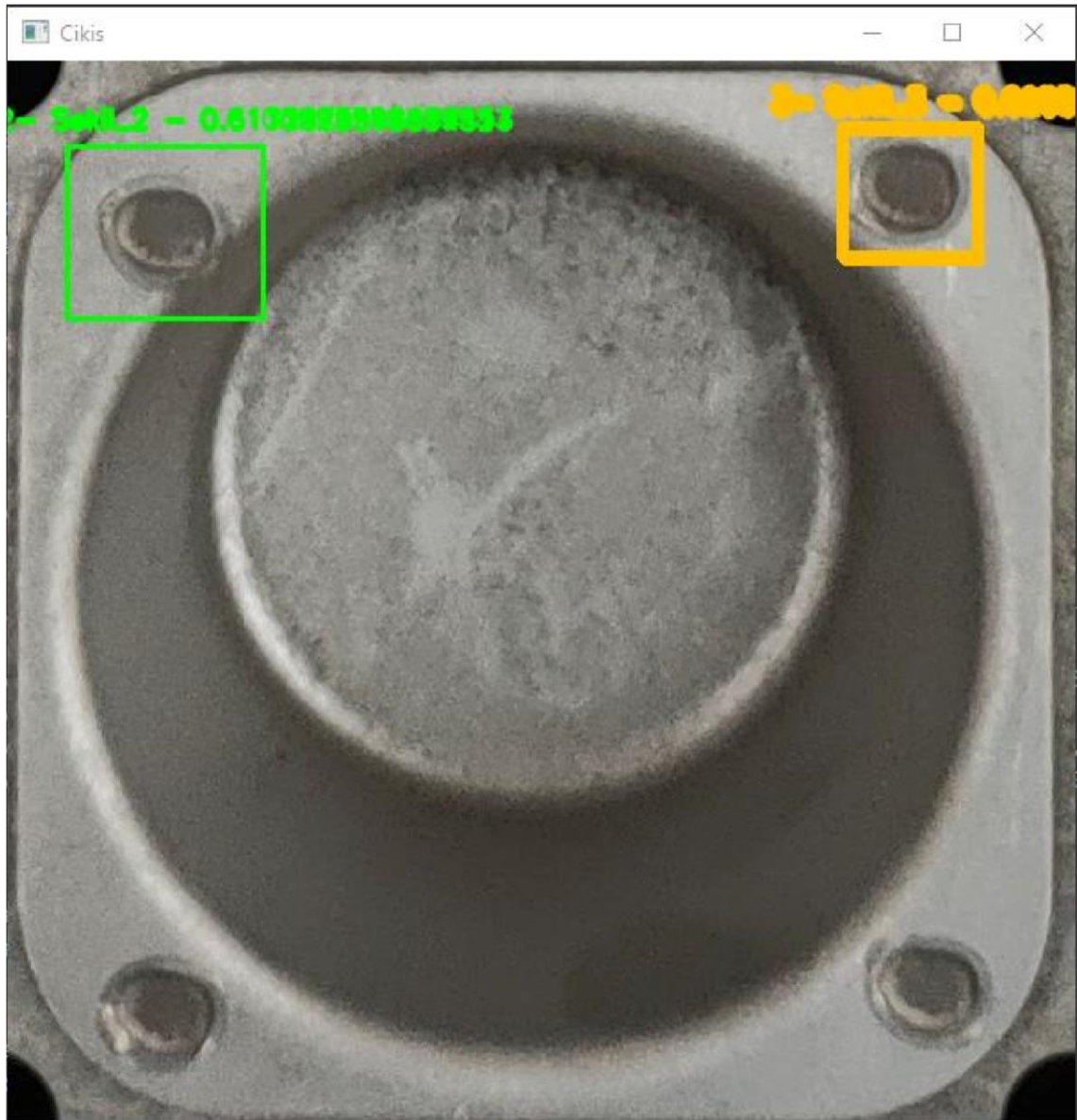
Şekil 4.4. Şablon Eşleştirme Algoritması Sonuçları
